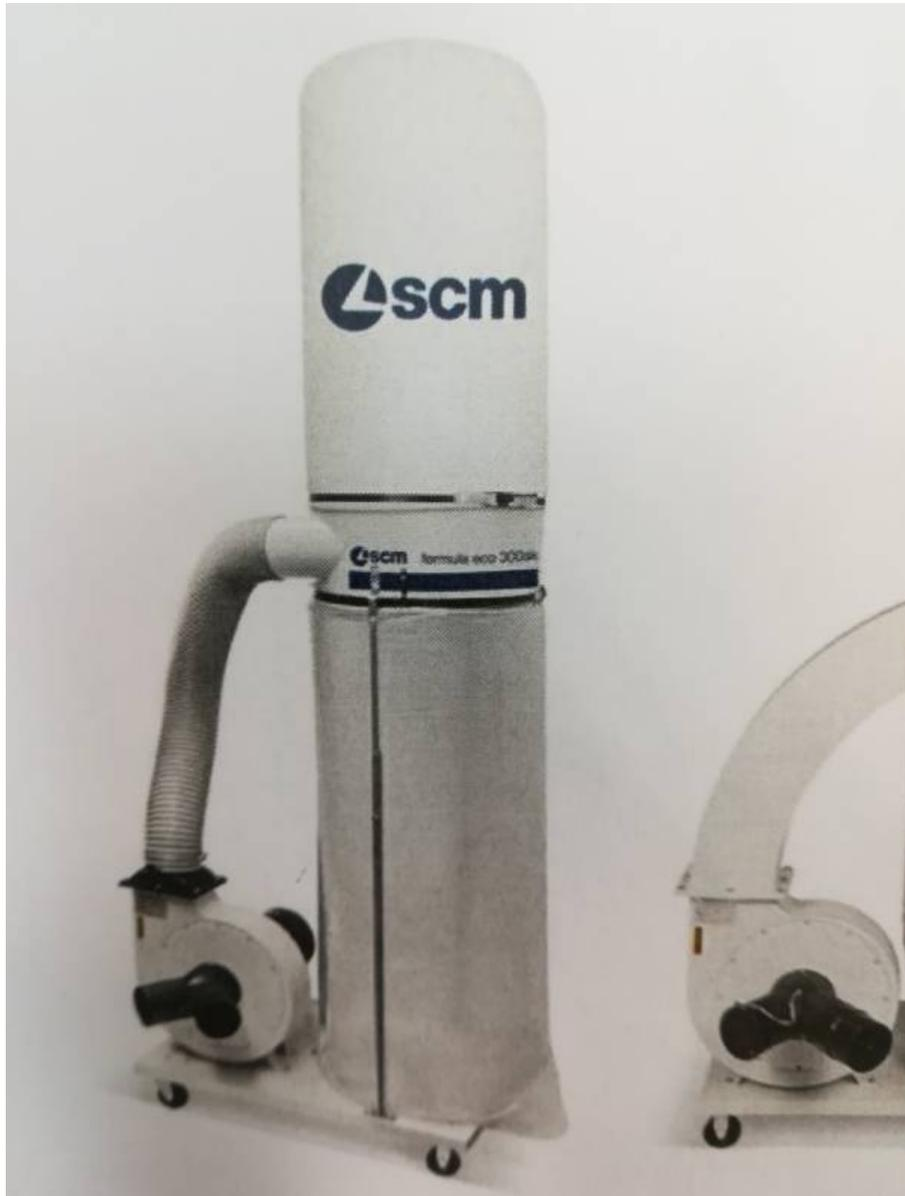
**Descrizione:** ASPIRATORE SCM FORMULA MOD. ECO 300SK - a norme CE - 1 sacco - capacità di aspirazione m<sup>3</sup>/h. 2550 - diam. sacchi mm. 500 - motore trifase
