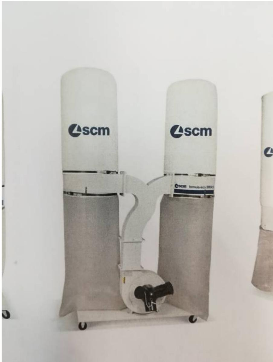
**Descrizione:** ASPIRATORE SCM FORMULA MOD. ECO 300D TRIFASE - a norme CE - motore trifase - a 2 sacchi - capacità di aspirazione m<sup>3</sup>/h. 3900 - diam. sacchi mm. 500 Dati tecnici: - Diametro ventola mm 305 - Numero di attacchi all'aspirazione 3 - Diametro bocche aspirazione mm 100 - Capacità dei sacchi m<sup>3</sup> 0,45
