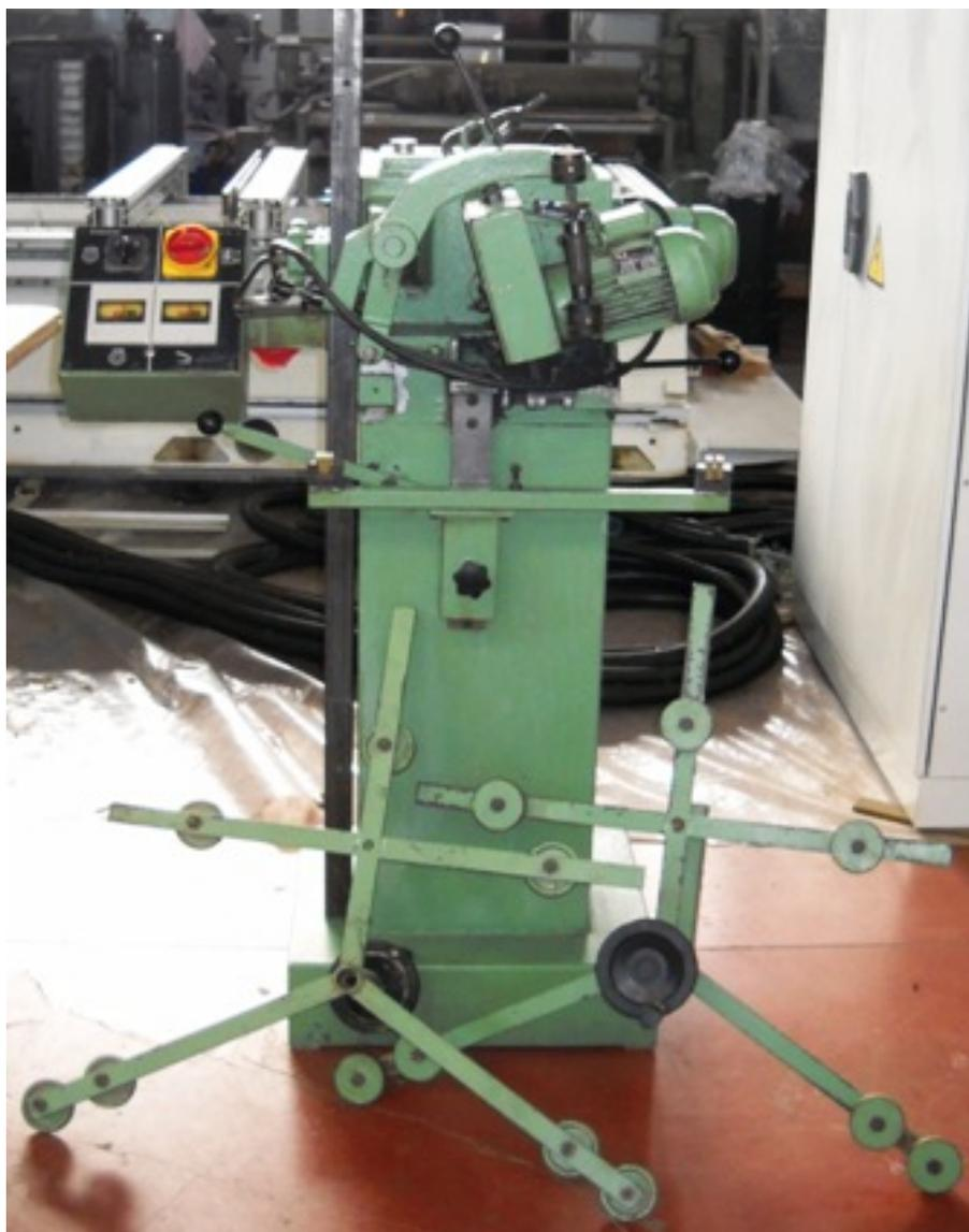
**Descrizione:** AFFILATRICE ORIZZONTALE PRIMULTINI MOD. APA 66 - motore mola 0,18 hp - diam. max mola 200 - passo dente 5-25 - larghezza lama da 15 a 60 mm. - angolo d'attacco da 5 a 20 gradi - spessore mola 7 mm.. - foro mola 15 mm. - motore cricco 0,18 kw - peso macchina 180 kg
