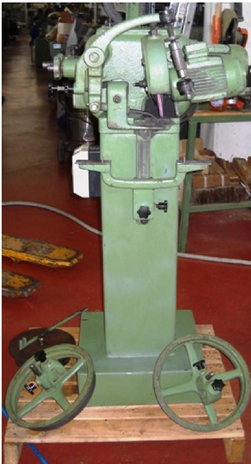
**Descrizione:** AFILATRICE PER LAME ORIZZONTALE PRIMULTINI MOD. AP 5 - passo dente 5-25
