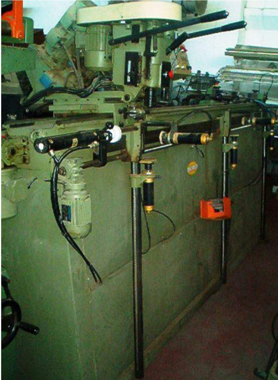
**Descrizione:** ANUBATRICE FABOC - avanzamento automatico - verticale - caricamento anuba manuale - posizionamento a camme
