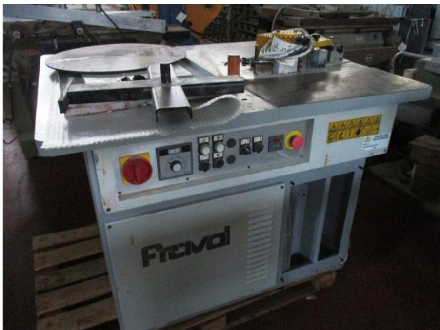
**Descrizione:** Bordatrice per curvi marca Fravol mod. A16/S - a normative CE - kw 2,5 - Kg 300
