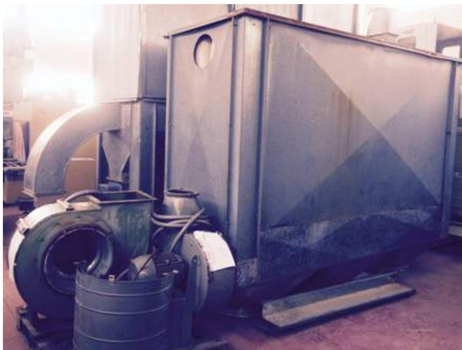
**Descrizione:** SOTTOSTAZIONE - mt.3 6000 - n. 48 maniche diam. 200 lunghezza mm. 1680 - aspiratore trucioli ME2 kw 7,5 hp 10 giri 2910 - n.1 motore trasporto trucioli hp 7,5 giri 2860 - con quadro elettrico
