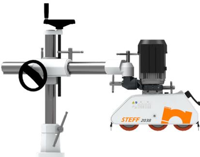
**Descrizione:** TRASCINATORE MAGGI MOD. 2038 + SUPPORTO STANDARD Numero di velocità avanti ed indietro 8 Velocità fisse 4 - 8 -11 - 22 mt/min Numero rulli 3 Diametro e spessore rullo 120 x 60 mm Motore 1 HP / 0,75 KW RPM 1400 2800 Sospensione rulli 20 mm Distanza fra il centro dei rulli 133 mm - 153 mm Distanza fra il centro primo e ultimo rullo 286 mm
