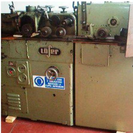
**Descrizione:** SCORNICIATRICE LOSER - attrezzata per fare pioli - 1° gruppo lame per incidere le tavole faggio, aiuta ad eliminare attrito e usura delle frese. È un'applicazione creata da un'artigiano - **MOTORI:** \*prima fresa kw 4 - 11 amper \*traino kw 1,5 - 6 amper \*ultime frese unico kw 11 - 23 amper
