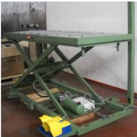
**Descrizione:** SOLLEVATORE IDRAULICO CASSIOLI - da mm. 2000x750 - con ruote traslanti
