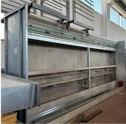
**Descrizione:** Cabina di verniciatura Pacini a secco - da mt. 6,20 altezza mt. 2,80 - n.2 ventilatori da 2 hp
