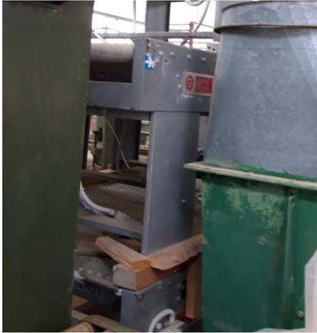
**Descrizione:** TRASPORTATORE A RULLI MOTORIZZATO TRANSFER SORBINI MOD. T20/R - larghezza mm. 1420 x lunghezza mm. 2000 - a norme CE - n.16 rulli diam. 80 - motore kw 0,4
