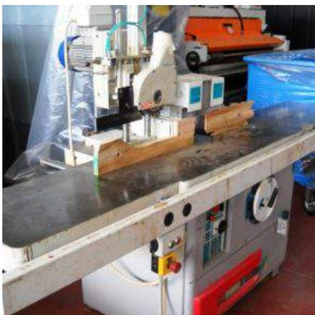
**Descrizione:** TOUPIE CASADEI MOD. F114L - albero fisso - a norme CE - piani lunghi - gruppo recupero listello con esclusione pneumatica motore kw 2,2 - toupie kw 4 - guida toupie con volantini
