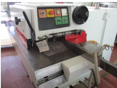
**Descrizione:** MULTILAME SCM MOD. M3 - altezza max di taglio mm. 120 - lunghezza min. di taglio mm. 350 - larghezza max pacco lame mm. 300 - diam. min. delle lame mm. 200 - diam. max. delle lame mm. 350 - larghezza del tappeto mm. 300 - altezza piano di lavoro mm. 750 - distanza basamento 1° lama mm. 220 - dimensioni del piano mm. 1530x750 - diam. bocca di aspirazione mm. 200 - motore hp 50 kw 37 - motore avanzamento hp 2 kw 1,5
