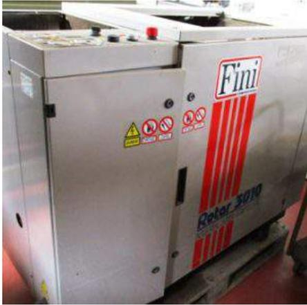
**Descrizione:** COMPRESSORE FINI TIPO E.C. ROTAR 30C10 23050 FS 80 GRI - a norme CE - HP 30 - lt. al min.2850 CFM 100,70 - bar 10 - PSI 145 - dB/A 72
