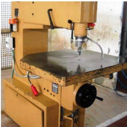
**Descrizione:** PANTOGRAFO SCM MOD. R9 Dati tecnici: - distanza tra albero e montante mm.915 - corsa verticale albero mm. 110 - corsa verticale del piano mm. 200 - max distanza tra piano e mandrino mm. 310 - attacco conico MK2 - velocità rotazione dell'albero 10000-20000 g/min. - motore kw 4 hp 5,5
