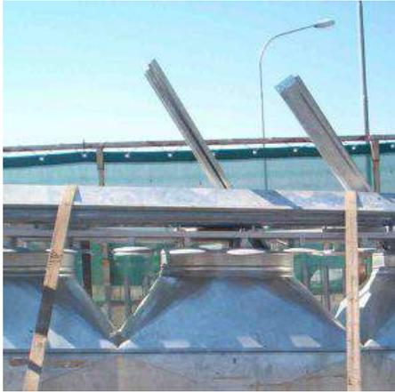
**Descrizione:** CASTELLO FILTRANTE - A 3 SACCHI DI RACCOLTA diam.600 - n.48 maniche diam.200 lungh.1600 - scuotitore aut.co - senza motore
