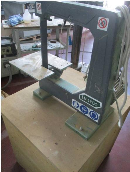
**Descrizione:** LEVIGATRICE A NASTRO CAPECCI E TROIANI MOD. LV1700 - a norme CE - motore kw 0,75 monofase
