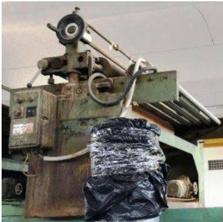
**Descrizione:** SPALMATRICE TINTEGGIATRICE PRITELLE RULLI DIAM.250 - 2 rulli sopra 1 acciaio 1 gomma - 2 rulli sotto 1 acciaio 1 gomma
