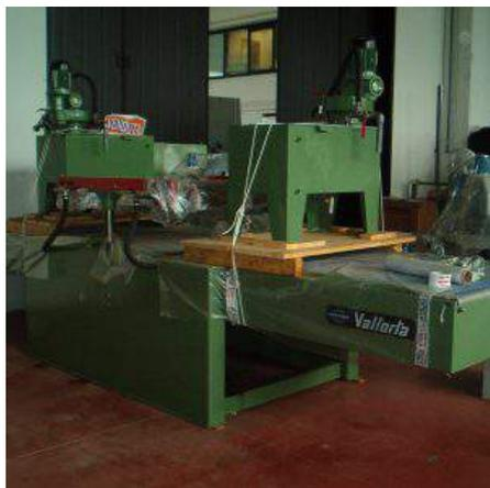
**Descrizione:** VELATRICE A DUE TESTE VALTORTA REVISIONATA - tappeti nuovi - larghezza utile mm. 900 - misure ingombro mm. 4600x1400 - velocità variabile (con variatore) - tappeti nuovi - larghezza utile mm. 900 - misure ingombro mm. 4600x1400 - velocità variabile (con variatore)
