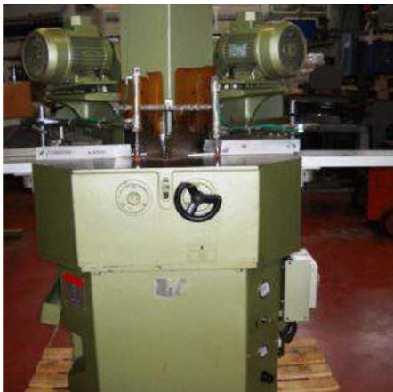
**Descrizione:** TRONCATRICE BILAMA MOTTA BREVETTI MOD. C6 - potenza teste kw 3 cad.
