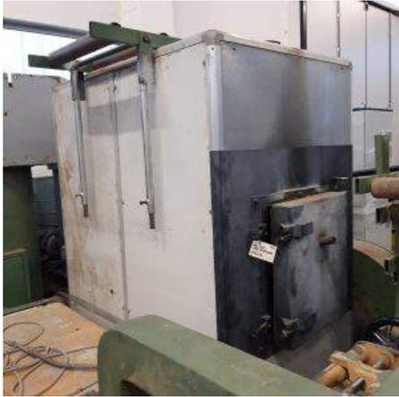
**Descrizione:** Impianto di riscaldamento con caricamento automatico METALREF Composto da: 1- Bruciatore-caldaia 2- Macinatore 3- Coclea-caldaia 4- Coclea 5- Coclea 6- Ventilatore 7-Ciclone + valvola stellare 8- kit Quadro elettrico
