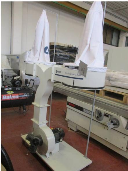
**Descrizione:** ASPIRATORE SCM FORMULA MOD. ECO 300D TRIFASE - a norme CE - motore trifase - a 2 sacchi - capacità di aspirazione m3/h. 3900 - diam. sacchi mm. 500 Dati tecnici: - Diametro ventola mm 305 - Numero di attacchi all'aspirazione 3 - Diametro bocche aspirazione mm 100 - Capacità dei sacchi m3 0,45
