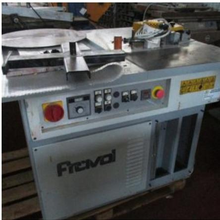
**Descrizione:** Bordatrice per curvi marca Fraval mod. A16/S - a normative CE - kw 2,5 - Kg 300
