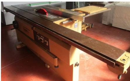
**Descrizione:** TENOSEGA SCM MOD. ST4W INCISORE - LAMA - TOUPIE - carro mm. 3200 - apertura mm. 1500 - albero diam. 35 mm.
