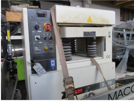
**Descrizione:** PIALLA A SPESSORE SCM MOD. S 520 - a norme CE - piano a spessore con n.2 rulli - terzo rullo d'avanzamento superiore motorizzato
