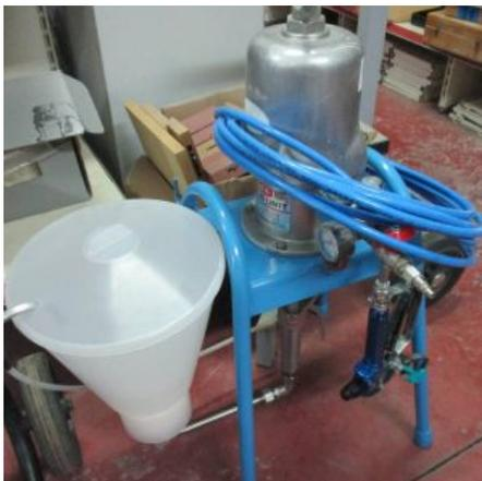
**Descrizione:** Pompa di verniciatura Iwata Airless Unit tipo PP 1251 - pressione max di esercizio ps11 bar - con serbatoio Completamente revisionata. Sostituito: - tubo ricircolo rilsan - tubo mandata 1/4-3/16x7,5 mt. - tramoggia lt.6 - kit guarnizione calotta - kit guarnizione pistone - rubinetto a.p. 1/4 - filtro c.p.100m - punteriuolosk9 - portaugello sc6 - ugello sc6 11-40 - rubinetto b.p. 1/4
