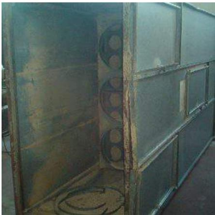
**Descrizione:** CASTELLO FILTRANTE A 27 MANICHE DIAM. 200 LUNGHE MM.2000 - n.3 sacchi di raccolta diam.500 - senza motore
