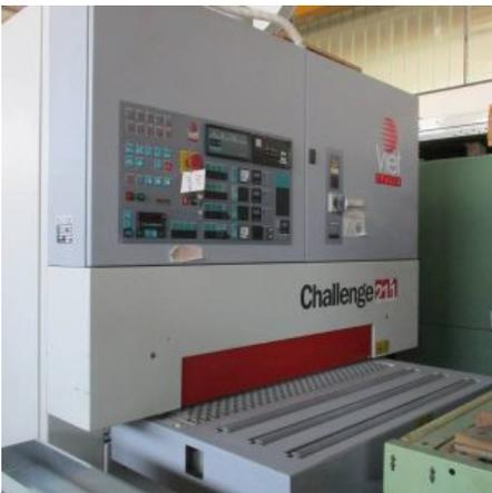
**Descrizione:** CALIBRATRICE VIET MOD. CHALLENGE 211 T.EL. da 1100 - primo rullo mm. 240 24 SH - tampone 24 settori \* adatto per impiallacciatura - motore hp 15 con variatore - soffiatore su entrambi i nastri - tappeto depressione - tampone sezionato elettronico - rulliera entrata e uscita
