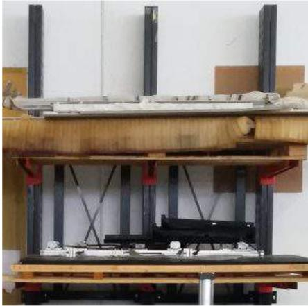
**Descrizione:** Cantilever monofronte - larghezza totale mm. 1900 - montanti interasse mm. 90 Composto da: - 3 colonne h.mm. 3500 - 6 mensole da mm. 900
