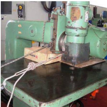
**Descrizione:** PANTOGRAFO OFG - con convertitore - discesa meccanica della testa - sbraccio da mm. 700 - motore hp 4,5
