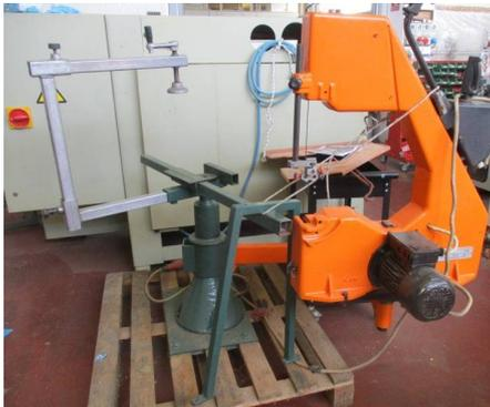
**Descrizione:** SEGA NASTRO DARIO MOD. SV3 MEDIA - con braccio snodabile - larghezza di taglio mm. 400 - altezza di taglio mm. 210 - max lunghezza della lama mm. 2450 - lunghezza nastro abrasivo mm. 2400 - spessore lame mm. 3,6/10 - max larghezza nastro abrasivo mm. 30
