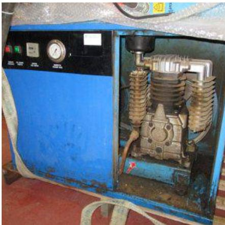
**Descrizione:** Compressore CE 0302 - a norme CE - silenziato - pressione max esercizio PS 11 Bar
