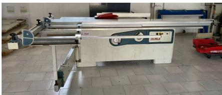
**Descrizione:** SEGA CIRCOLARE TECNICA TYPE SI 3200 - a norme CE - diam. lama mm. 300 - con incisore diam. mm. 120 - motore kw 4
