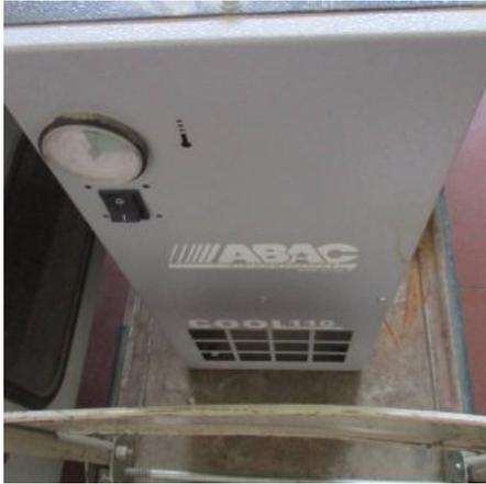
**Descrizione:** ESSICCATORE BALMA MOD. COOL 110 Seminuovo - pressione max bar 16 - capacità trattamento aria l/min 1825 mt.3/h. 110 - potenza W.293
