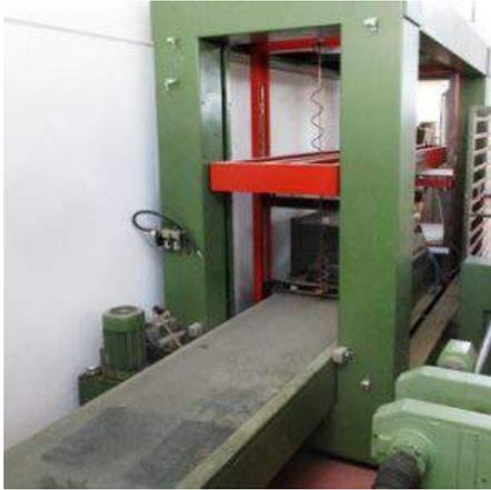
**Descrizione:** STRETTOIO PER CORPI DI MOBILI TERMOPAK MOD. STI - larghezza 700 mm. - altezza mm. 1200 - lunghezza mm. 2600
