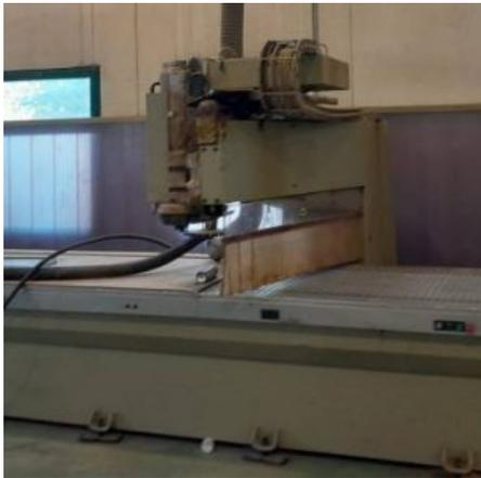
**Descrizione:** CENTRO DI LAVORO SCM MOD. RECORD 220 - a norme CE - n.3 assi - corsa assi X - Y = mm. 3250x1300 - campo di lavoro: \*con gruppo operatore di fresatura mm. 3180x1250 \*con tutti gruppi operatori mm. 2860x1160 - passaggio pezzo mm. 320 - piano multifunzionale mm. 5200x1200 - pompa del vuoto 250 - controllo NUM - cambio utensili RAPID 10
