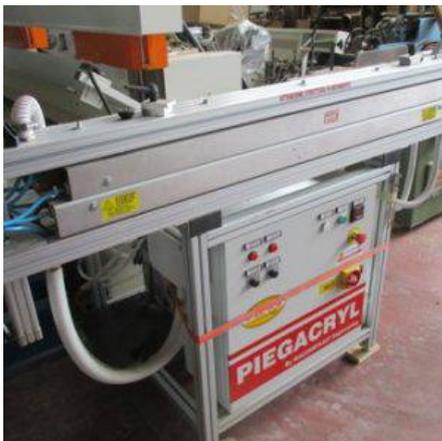
**Descrizione:** MACCHINA RISCALDANTE PER PIEGATURA LASTRE TERMOPLASTICHE MALCOMPLAST MOD. PIEGACRYL - normative CE - indicata per la piegatura di lastre di elevato spessore sino a 15-20 mm. - raffreddamento ad acqua - lunghezza utile lavoro mm.1240 - alimentazione elettrica 220/380 volt - alimentazione pneumatica 5 atm - larghezza zona riscaldata 8-80 mm. - regolazione in altezza delle resistenze +-8mm.
