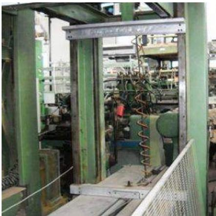
**Descrizione:** STRETTOIO PER CORPI DI MOBILI TERMOPAK - passante - apertura max 2500x1500 - doppio tappeto trasportatore
