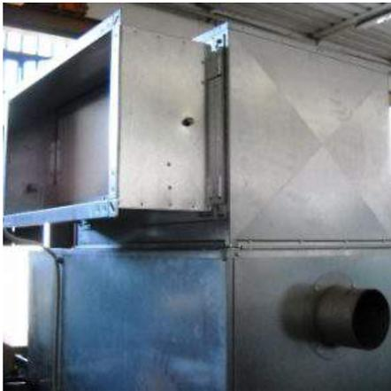
**Descrizione:** GENERATORE CON CENTRALINA A METANO BPS CLIMA MOD. B23 - a norme CE - con serranda tagliafuoco - bocchetta superiore in uscita - SENZA BRUCIATORE
