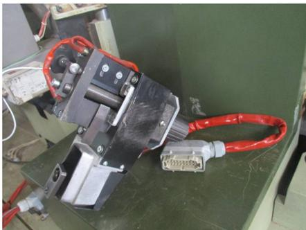
**Descrizione:** VASCA COLLA REVISIONATA PER BORDATRICE MOD. SELECTA 12 E ALTRE TIPOLOGIE DI BORDATRICI DA VERIFICARE REVISIONATA CON SOSTITUZIONE DI: - N.2 CUSCINETTI - N.1 GUAINA CAVO - N.1 MATERIALE DI CONSUMO
