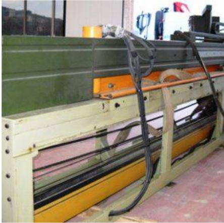
**Descrizione:** Sezionatrice Scm mod. ALFA45C - profondità di taglio mm. 3500 - n.2 pianetti a velo d'aria mm. 1500 - n.1 pianetto a velo d'aria mm. 2500 - n.8 pinze
