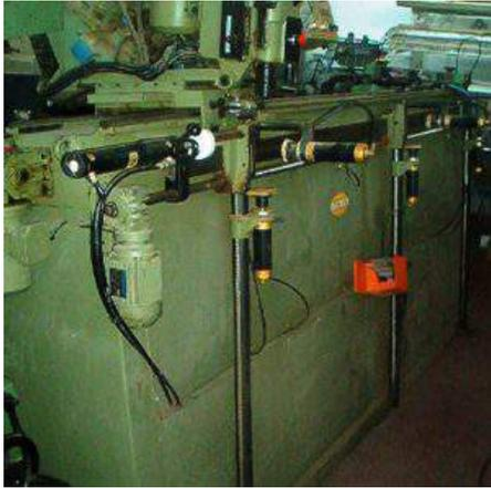
**Descrizione:** ANUBATRICE FABOC - avanzamento automatico - verticale - caricamento anuba manuale - posizionamento a camme
