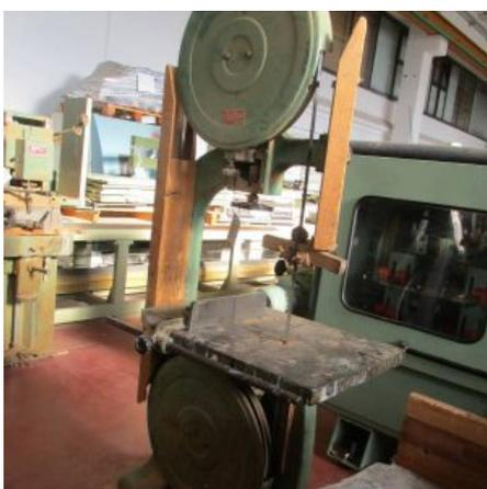
**Descrizione:** SEGA A NASTRO diam. 600 - volani a raggi - motore hp 3 (?)
