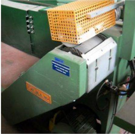
**Descrizione:** LEVIGATRICE C.A.M.A.M. MOD.LOL/75/RU - MATRICOLA N.21 - GRUPPO D'AVANZAMENTO PER PEZZI TONDI,QUADRI, PIATTI - MOTORE LEVIGATRICE HP 7,5 - MOTORE AVANZAMENTO HP 0,35 - A TRE VELOCITA' - DIMENSIONI NASTRO ABRASIVO MM.200X3000 - MISURE D'INGOMBRO MM750X1500 H1400 - PESO KG 420
