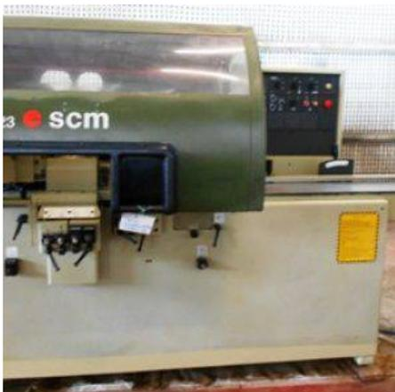
**Descrizione:** SCORNICIATRICE SCM MOD. COMPACT 23 - massima larghezza utile di lavoro (sezione finita) mm. 230 (con utensile diam. mm. 140 su verticale sx) - massima altezza utile di lavoro (sezione finita) mm. 125 - lunghezza utile alberi orizzontali mm.245 - lunghezza utile alberi verticali mm. 140 - diam. in.utensili per profilare mm. 100 - diam. massimo utensile per profilare mm. 180
