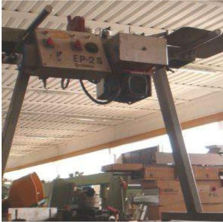
**Descrizione:** BORDATRICE CEHISA MOD. EP-2S - motore KW.0,25 - con TAGLIERINA - a colla termofondente - per bordi singoli o a rotoli in melaminico, laminato, PVC, impiallacciatura - righette. - Distribuzione della colla sul pannello con cilindro motorizzato. - Facilità di regolazione. - Praticità, semplicità d'uso. - Dati tecnici: \*altezza bordo max 50 mm. \*spessore max bordo 3 mm. \*motore trifase 220/380 v.
