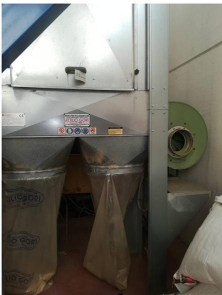
**Descrizione:** FILTRO ASPIRMECC MOD. AM2/18 CS HP4 - a norme CE - n. 18 maniche filtranti - 2 sacchi di raccolta - motore hp 4 - portata mt.cubi/h. 3060
