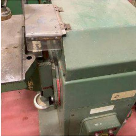
**Descrizione:** MORTASATRICE PADE MOD. MSO - semplice aut.ca oscillante (avanzamento della tavola - punta oscilla) - n. 1 punta - carico e scarico manuale
