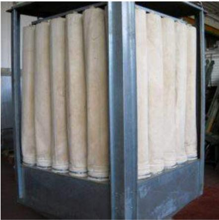
**Descrizione:** FILTRO PER BRICCHETTATRICE - n.36 maniche diam. 200 mm. lunghe mm. 1500 - con scuotitore elettrico - con bocca diam. 1000 - senza motore - senza carenatura - dimensioni mm 1600x1600 h=2500 - virola d.1000 - dimensioni ingombro: h.2600x1600x1600 mm.
