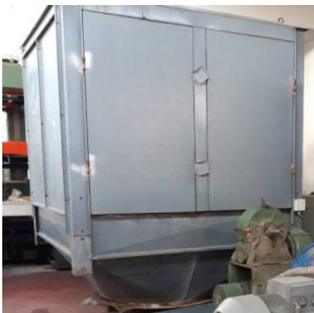
**Descrizione:** FILTRO PER BRICCHETTATRICE - n.36 maniche filtranti diam. 250 mm. x 1300 mm. di altezza - con scuotitore - virola diam. mm. 1200
