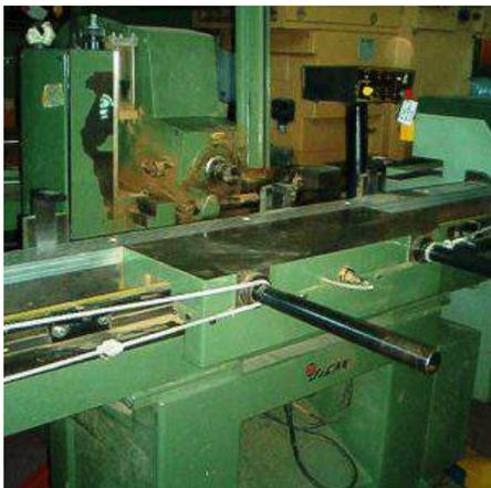
**Descrizione:** ANUBATRICE SICAR A 1 TESTA - orizzontale - caricamento anuba da 14 automatico - spostamento carrello manuale con battute meccaniche
