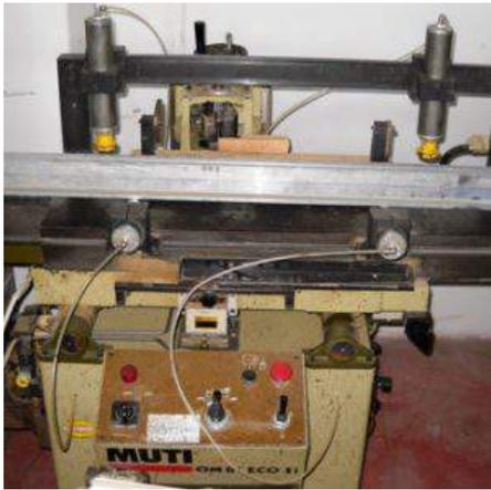
**Descrizione:** BEDANATRICE MUTI MOD. OMB1 ECO SI - dimensione del piano di lavoro mm. 250x1000 - altezza piano di lavoro mm. 860 - corsa longitudinale piano di lavoro mm. 350 - profondità max di lavoro mm. 130 - regolazione verticale della testa mm. 100 - motore testa hp 3 - motore centralina idraulica hp 0,5
