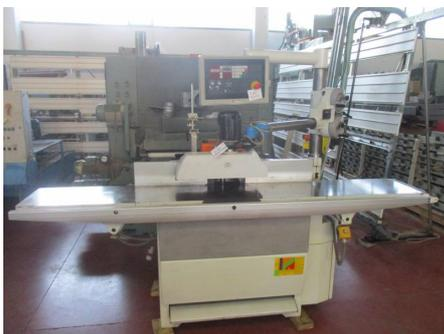
**Descrizione:** TOUPIE SCM MOD. T130E - piani versione LL - quadro comando pensile - inverter da 3300/10.000 g/min - supporto trascinatore completa di: TRASCINATORE MASTERWOOD A 4 RUOTE
