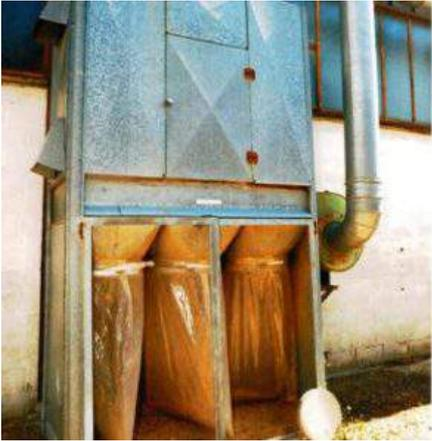
**Descrizione:** FILTRO - n.3 sacchi di raccolta diam. 600 - con elettroventilatore - n.18 maniche diam.250 lunghezza mm.1500 - motore kw 5,5/hp 7,5
