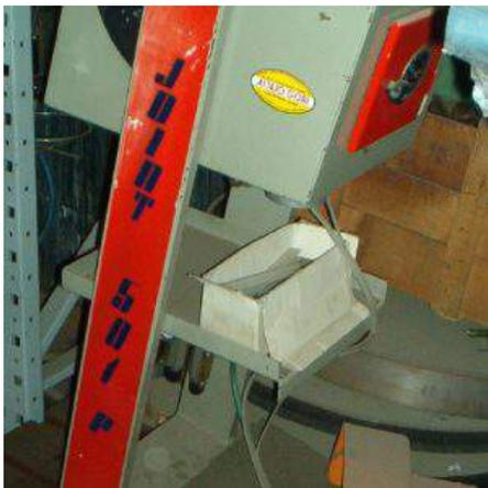
**Descrizione:** GRAFFATRICE OMGA JOINT 501 P - graffatrice pneumatica verticale per l'assemblaggio di quadri in legno di ogni essenza - squadra di appoggio scorrevole per poter inserire due graffe alla distanza desiderata predisponendola con l'ausilio di due fermi - pressore frontale che assicura un migliore bloccaggio dei due pezzi durante l'operazione di aggraffatura.
