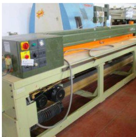
**Descrizione:** SEZIONATRICE SCM MOD. Z32 - trifase Dati tecnici: - lunghezza utile di taglio mm. 3050 - altezza max di taglio con diam. lama principale mm. 350 mm. 80 - profondità utile di taglio per tagli longitudinali con spintore manuale mm. 1300
