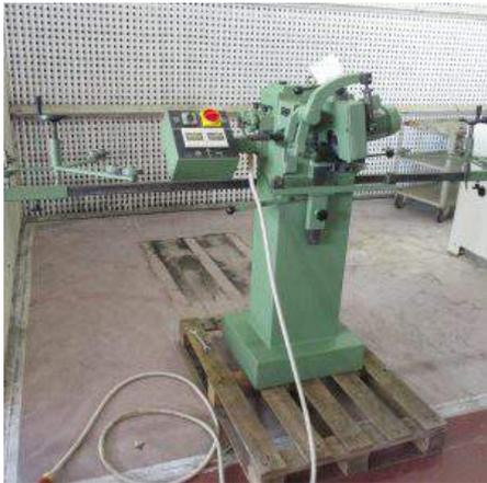
**Descrizione:** Affilatrice per nastri Primultini mod. Apa57 - mola diam. max 200 mm. - n.max mm. 3340 giri/min.
