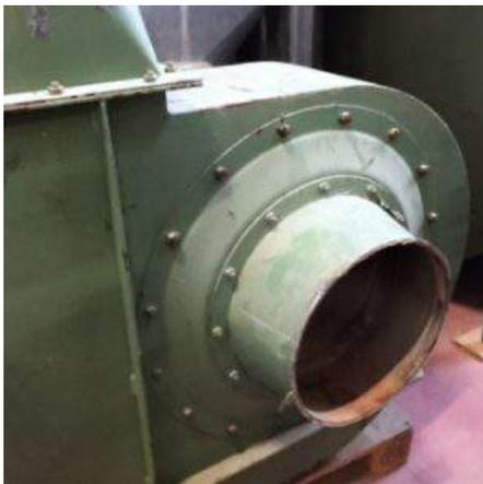
**Descrizione:** ELETTOVENTILATORE - motore 11kw 15hp giri al minuto 2900
