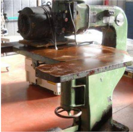
**Descrizione:** PANTOGRAFO Ofec - discesa meccanica - potenza motore hp 1,5 monofase
