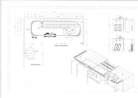
**Descrizione:** CATENA DI VERNICIATURA PER SERRAMENTI AUTOMATICA VERTEK - a norme CE Completa di: - trasportatore aereo birotaia - n.46 ganci - cabina di verniciatura a secco mod. C.V.SG. 4000 speciale - Flow-Coating teflonato - quadro elettrico di gestione impianto - struttura portante - piattaforma di sollevamento - tunnel di essiccazione
