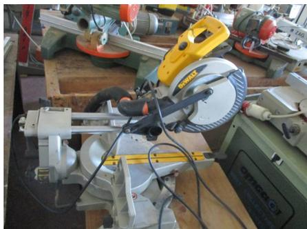
**Descrizione:** TRONCATRICE DEWALT MOD. DW712-GB TIPO 1 - a normative CE - lama diam. 216 mm. - 1600 watt - taglio max 70 mm.
