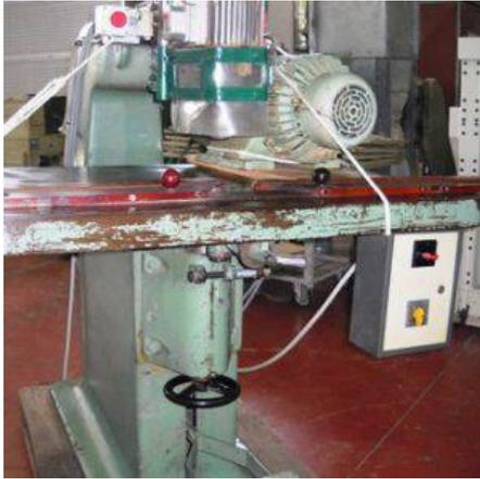
**Descrizione:** PANTOGRAFO OFG - con convertitore - sbraccio da mm. 900 - discesa meccanica - potenza elettromandrino hp5,6 g.min.12.000-18.000
