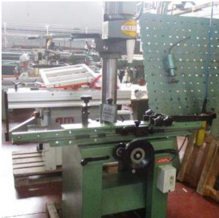
**Descrizione:** CAVETTATRICE PER PERSIANE PER CURVI FIN MOD. CP86//650 - motore trifase hp2 - giri punta 14.000 - dimensioni cm. 1300x950x1820 - peso netto 150 kg. - inclinazione delle cave regolabile 0°- 65° - possibilità di eseguire sestri fino ad un raggio mm.650 - peso delle cave a richiesta n. passi 4 - diametro punta a richiesta mm.9/12
