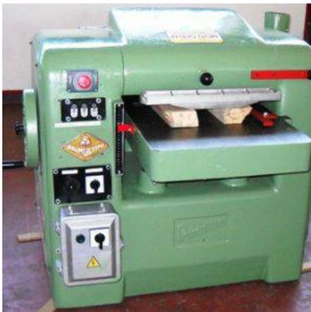
**Descrizione:** PIALLA SPESSORE PRIMULTINI DA MM 500 CON SOLLEVAMENTO MANUALE N.2 TOUPIE IN USCITA MAX ALTEZZA LAVORABILE MM.240 - motore pialla hp 5,5 + motore sollevamento hp 0,8 + n.2 motori toupie kw 4 cad. COMPLETAMENTE REVISIONATA
