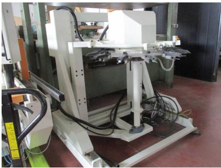
**Descrizione:** MAGAZZINO CAMBIO UTENSILE SUPPLEMENTARE SCM PER ACCORD A 12 POSIZIONI
