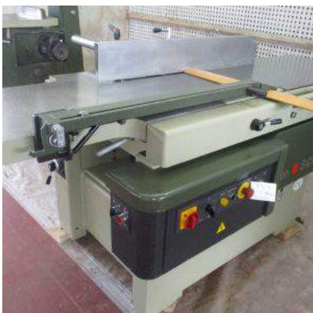
**Descrizione:** PIALLA FILO SPESSORE SCM MOD. FS520 - a norme CE - larghezza utile albero 520 mm. - velocità di rotazione 5.000
