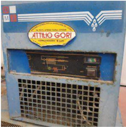
**Descrizione:** Essiccatore Omi mod. TMC 96 - a normative CE - portata 1600 l/min. - pressione max esercizio 12 Bar - alimentazione 230/1/50 - potenza installata 0,62 kw - refrigerante R22-0,33 kg. - temp. max aria 45°C
