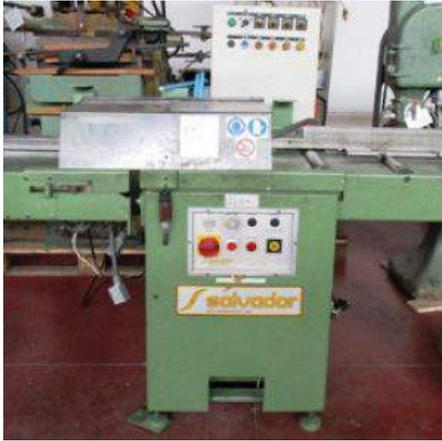
**Descrizione:** OTTIMIZZATRICE SALVADOR MOD. TVB/400 - a normative CE - potenza installata kw 3 - dimensione lama mm. 400 - sezione di taglio mm. 250x80 - Dimensioni di ingombro: \*larghezza mm. 920 \*lunghezza mm. 6230 \*altezza mm.1400
