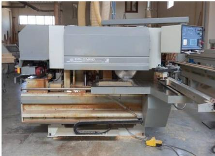
**Descrizione:** Centro di lavoro per finestre Colombo mod. AM33/C - a normative CE Composizione: - gruppo lama controllo elettronico intestatura - gruppo tenonatura da mm. 620 - intervento a tempo albero mm. 270 - albero profilatura mm. 620 - albero ferramenta 2 posizioni - recupero listello
