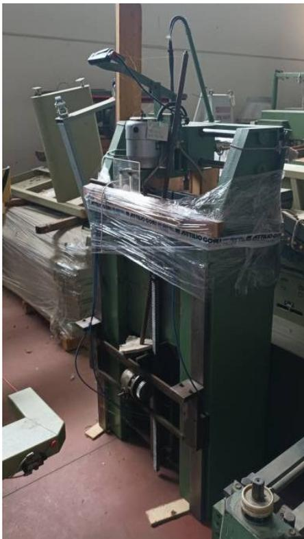
**Descrizione:** Pantografo U.Gabrielli mod. MINI TRILLO - motore fresa watt 2000 ELU - g.minuto utensili fresa 18.000 - escursioni del piano di lavoro mm. 1000 - corsa longitudinale mm. 680 - corsa trasversale mm. 200 - profondità di fresatura mm. 80 - dimensioni ingombro: \*altezza mm.1800 \*larghezza mm. 900 \*profondità 600 - peso kg. 250
