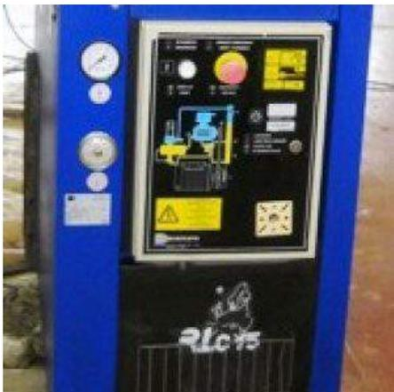
**Descrizione:** COMPRESSORE CECCATO MOD. BLC 15-8 - motore kw 11 cavalli 15 - pressione esercizio 8 bar - a normative CE
