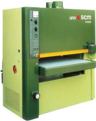
**Descrizione:** CALIBRATRICE LEVIGATRICE AUTOMATICA SCM MOD. SANDYA UNO C-CS Dati tecnici: - mm. 920 - altezza max di lavoro mm. 160 - altezza min di lavoro mm. 3 - dimensione nastri abrasivi mm. 930x1525 - potenza motore principale hp 10
