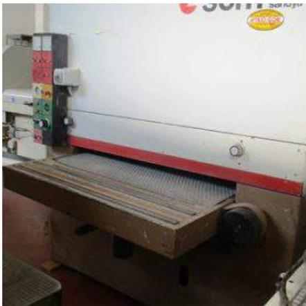
**Descrizione:** CALIBRATRICE SCM MOD. CL2R/110 - variat. vel. tappeto - 1° rullo 65 Sh - motore hp 12,5-15 - 2° rullo 35 Sh - motore hp 10 - soffiatori 1° e 2° nastro - diam. rulli mm. 320 - piano flottante - tappeto forato senza depressione - n.4 bocchette aspirazione diam. 150 - sv. nastri 2150x1115 mm.
