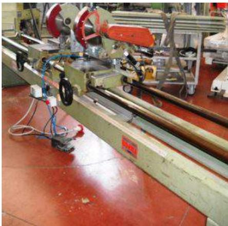
**Descrizione:** TRONCATRICE OMGA MOD. TR2A - diam. lame mm. 300 - taglio utile mm. 3500
