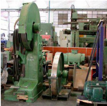
**Descrizione:** SEGA TRONCHI PRIMULTINI MOD. SE-CEA-IEA da 1100 - senza CE - sinistra - mt.15 di binario - motore hp 40 - fascia volani mm.120 - sollevamento gruppo lama motorizzata - carro a 4 morse con chiusura manuale - completo di binario - divisore per spessori elettrico - avanzamento e ritorno del carro con cremagliera
