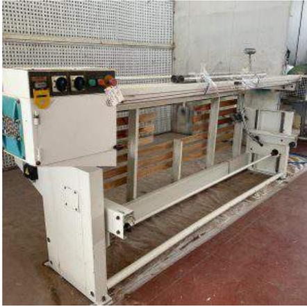
**Descrizione:** LEVIGATRICE A NASTRO MINIMAX MOD. L/S 3000 - a normativa CE - motore hp4 kw 3 ad una velocità - lunghezza piano di lavoro mm. 3000 - larghezza del piano di lavoro mm. 1100 - corsa verticale del piano mm. 580 - larghezza del nastro abrasivo mm. 150 - sviluppo del nastro abrasivo mm. 8100 - velocità di scorrimento del nastri mt./sec. 140 - profondità del collo montanti mm. 820 - diam. pulegge mm. 250 - motore sollevamento hp 0,5
