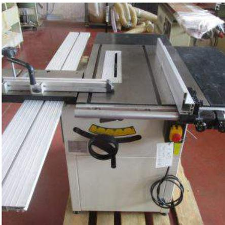
**Descrizione:** SEGA CIRCOLARE DAMATO MACCHINE MOD. VOYAGER SC2 - a normative CE Caratteristiche tecniche: - dimensioni tavolo principale mm. 720x480 - dimensione lama max mm. 254 - foro lama mm. 30 - velocità lama 4000 rpm - potenza motore 1,5 kw 240V 1 monofase - max profondità di taglio a 90° mm. 80 - max profondità di taglio a 45° mm. 56 - peso kg. 120
