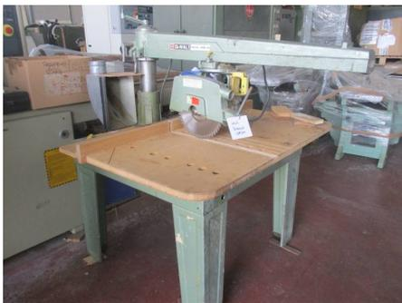
**Descrizione:** RADIALE DEWALT RADIAL ARMS SAWS MOD. 1875 - lama diam. 300 - motore hp 3
