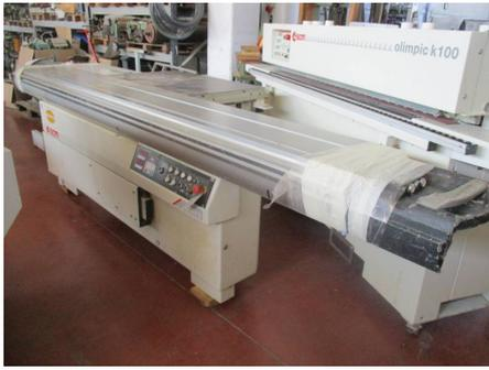
**Descrizione:** SEGA CIRCOLARE SCM MOD. SI350 E - carro da mm. 3200 - a norme CE - pulsanti marcia/arresto integrati nel carro scorrevole - guida a squadrare "quick look" con rullo esten. - guida parallela con posizionatore elettronico - diam. albero sega 30 mm
