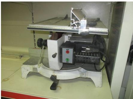
**Descrizione:** TRONCATRICE PEGIC MOD. R 300 SI - a norme CE - motore kw 2,1 monofase - lama diam. 300 foro 30 spessore 3,2
