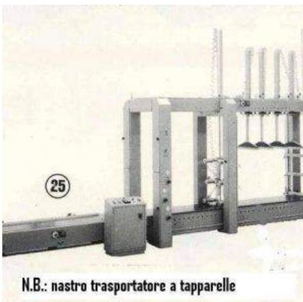
**Descrizione:** STRETTOIO PASSANTE PER CORPI DI MOBILI COMIL S/2 - semiautomatico - con banco di assemblaggio
