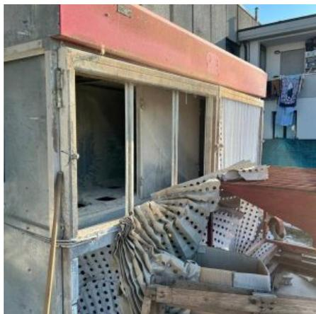
**Descrizione:** CABINA DI CARTEGGIATURA BISMAK MOD. MULT 3000 - a norme CE - motore kw 4 - portata di esercizio mt.3/h 7500
