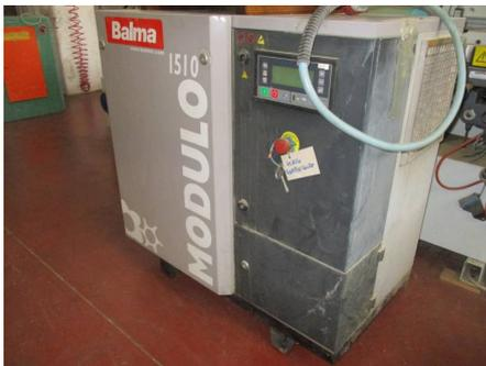
**Descrizione:** COMPRESSORE BALMA MOD. 15/51 - a norme CE - portata aria libera 1.72 m3/min. - potenza installata kw 15 - pressione di esercizio 10 bar
