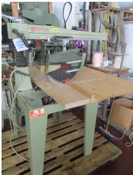
**Descrizione:** RADIALE STROMAB MOD. RS65 - motore hp3 trifase - lama diam. 300
