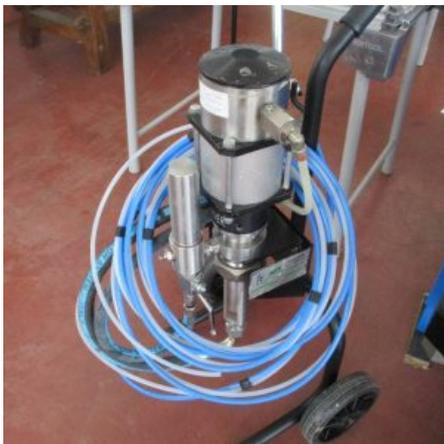
**Descrizione:** POMPA DI VERNICIATURA - a norme CE Completamente revisionata. Sostituito: - pistola airmix mach 3 completa - tubo aspirazione 36x - 1/2 - tubo binato airmix 1/4 - 3/16x7,5 - tubo ritorno M20x2 - ministaccio 1/2 - kit guarnizioni calotta - kit guarnizioni pistone
