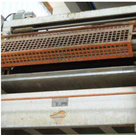
**Descrizione:** INCOLLATRICE FIN MOD. SC4/92 1300 Dati tecnici: - larghezza di lavoro mm. 1300 - passaggio max fra i rulli mm. 120 - diam. dei rulli mm. 250 - velocità di avanzamento mt./1' 19 - potenza di ciascun motore hp 0,75
