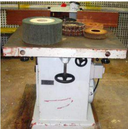
**Descrizione:** LEVIGATRICE A RULLO MALESA MOD. ZAD250 - rullo diam. 250 - piano fisso dim.900x1000 - motore per aspirazione polveri - motore albero hp 2
