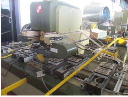
**Descrizione:** CENTRO DI LAVORO MASTERWOOD MOD. PROJECT 309 - assi n.3 - barre n. 6 - corsa asse X utile mm. 2230 - corsa asse Y mm. 820 - corsa Z mm. 80 - pompa del vuoto da mt. cubi 40 - consumo totale macchinario KW 15 - GRUPPO ELETTROMANDRINO - GR. LAMA ROTAZIONE MANUALE - ELETTROMANDRINO - PANTOGRAFO C.U. 309 313 - DISPOSITIVO BLOCCAGGIO PEZZI STRETTI
