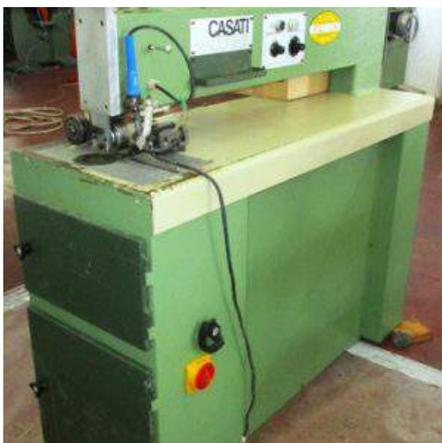
**Descrizione:** GIUNTATRICE A FILO CASATI MOD. Z1000 - sbraccio mm.1000 - spessore materiale mm.0,4-2 - velocità di avanzamento variabile m/min.10-25
