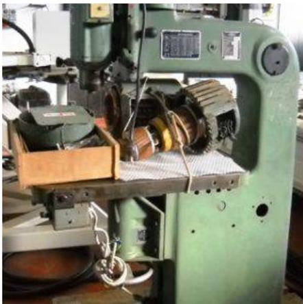
**Descrizione:** PANTOGRAFO KNOHOMA MOD. KOF.K - da 600 - motore potenza kw 2,2 - con convertitore di frequenza \*entrata v220/380 \*uscita v110/165 \*kva 4
