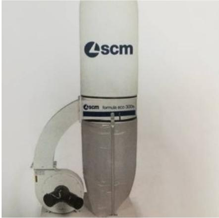
**Descrizione:** ASPIRATORE SCM FORMULA MOD. ECO 300S TRIFASE - a norme CE - 1 sacco - capacità di aspirazione m<sup>3</sup>/h. 2550 - diam. sacchi mm. 500
