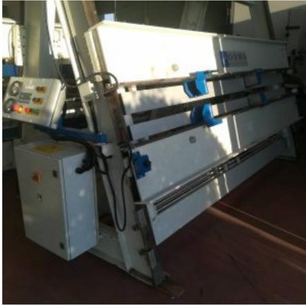
**Descrizione:** STRETTOIO ORMA MOD. FUTURA 30/17 - Dimensioni utili di lavoro mm. 3000x1700 - n.2 pistoni orizzontali 65/45 corsa mm. 1200 - n.2 pistoni verticali 65/45 corsa mm. 800 - Spinta tot. Pistoni verticali ton. 14 - Spinta tot. Pistoni orizzontali ton. 6 - carter su cremagliera
