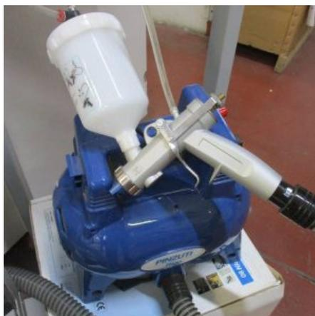
**Descrizione:** PISTOLA PER VERNICIARE TURBINA PIN 80 COMPLETA DI TUBO
