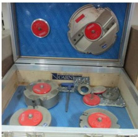
**Descrizione:** CASSETTA FRESE GARNIGA Così composte: - n.2 fresa a spessore variabile multiuso diam. 140x50x35 - n.3 fresa per piattabanda tipo 4x4 diam. 220 - n.3 frese per profili sagomati con inserti intercambiabili in HSS
