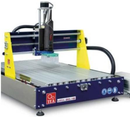
**Descrizione:** FRESATRICE CN DA BANCO SERIE MAX - motore 1050 Watt Reg.220v - corsa X 800 - corsa Y 450 - corsa Z 100 - viti e guide a ricircolo di sfere - piano standard in multistrato - collegamento con linea seriale x PC (PC non fornito) - piano di lavoro in alluminio con cave a T.
