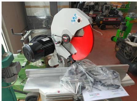
**Descrizione:** TRONCATRICE PEGIC MOD. GP350RT - SENZA PIANETTO SUPERIORE - MOTORE AUTOFRENANTE COMPLETA DI: \*N.2 MORSE MANUALI \*BATTUTA RIBALTABILE \*MANIGLIA A COMANDO MANTENUTO - TRIFASE
