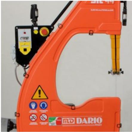
**Descrizione:** SEGA A NASTRO DARIO MOD. SET1500-SN44 - trifase - con braccio snodabile - vagone mobile - pressore P-250 e supporto materiale - a norme CE
