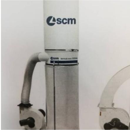
**Descrizione:** ASPIRATORE SCM FORMULA MOD. ECO 300SK - a norme CE - 1 sacco - capacità di aspirazione m<sup>3</sup>/h. 2550 - diam. sacchi mm. 500 - motore trifase
