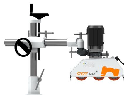
**Descrizione:** TRASCINATORE MAGGI MOD. 2038 + SUPPORTO STANDARD (LUNGHEZZA COLONNA ORIZZ. mm.705) Numero di velocità avanti ed indietro 8 Velocità fisse 4 - 8 -11 - 22 mt/min Numero rulli 3 Diametro e spessore rullo 120 x 60 mm Motore 1 HP / 0,75 KW RPM 1400 2800 Sospensione rulli 20 mm Distanza fra il centro dei rulli 133 mm - 153 mm Distanza fra il centro primo e ultimo rullo 286 mm
