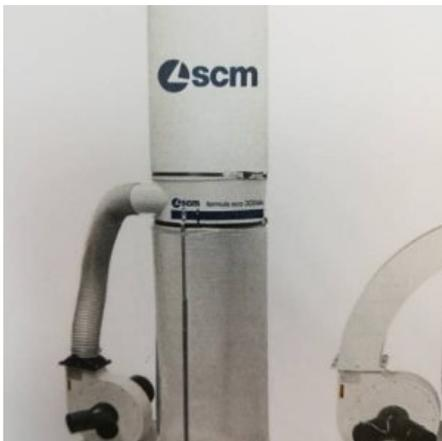
**Descrizione:** ASPIRATORE SCM FORMULA MOD. ECO 300SK - a norme CE - 1 sacco - capacità di aspirazione m<sup>3</sup>/h. 2550 - diam. sacchi mm. 500 - motore monofase
