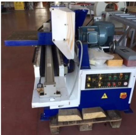
**Descrizione:** FRESATRICE FINGER JOINTING MOD. FJL MXB 3515 C Completa di : - disco intermedio LO - pettine regolabile standard FJL - flangia speciale per pacco frese
