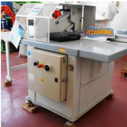
**Descrizione:** TRONCATRICE IDRAULICA STROMAB MOD. TR600 - motore hp 12,5 - lama diam. 600 - capacità a troncatura sezione 420x160 o 610x30 mm. Completa di: - piano di lavoro a dx della lama - piano di lavoro a sx della lama - lama al widia - griglia di protezione su zona taglio
