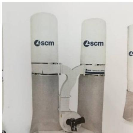
**Descrizione:** ASPIRATORE SCM FORMULA MOD. ECO 300D TRIFASE - a norme CE - motore trifase - a 2 sacchi - capacità di aspirazione m<sup>3</sup>/h. 3900 - diam. sacchi mm. 500 Dati tecnici: - Diametro ventola mm 305 - Numero di attacchi all'aspirazione 3 - Diametro bocche aspirazione mm 100 - Capacità dei sacchi m<sup>3</sup> 0,45
