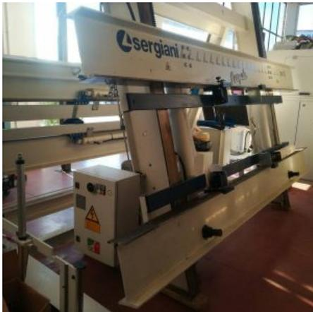
**Descrizione:** STRETTOIO SCM SERGIANI MOD. SM-K 30-20 - dimensioni max di lavoro 3000x2000 mm. - dimensioni min di lavoro 250x350 mm. - spinta verticale max 14 ton. - spinta orizzontale max 6 ton. - diam. cilindri/stelo orizzontali mm. 60/45 - corsa cilindri orizzontali mm.1200 - diam. cilindri/stelo verticali mm. 90/45 - corsa cilindri verticali mm. 1100 - altezza di lavoro mm. 400/920
