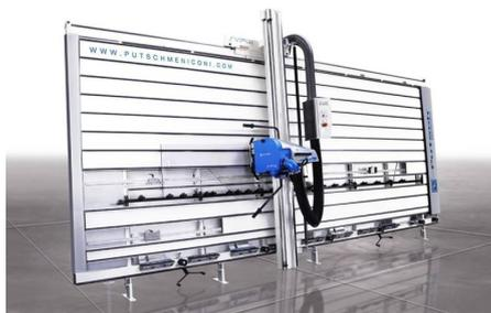
**Descrizione:** SEZIONATRICE VERTICALE PER PANNELLI PUTSCH MENICONI MOD. SVP 145 M PLUS ASP/CEN 4200/2200 - a norme CE Composizione: - battente supplementare mt.1 - dispositivo pezzi corti lato Dx L.4200 - appoggio scorrevole per pezzi stretti Dati tecnici: - max altezza di taglio verticale mm. 2200 - max lunghezza di taglio mm. 4200 - potenza motore hp5 kw3,7 - piano spostabile elettrico - ruote - aspirazione centralizzata
