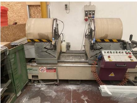
**Descrizione:** TRONCATRICE DOPPIA FOM MOD. BLITZ ALVA ECHO M - diam. max utensile mm. 450 - velocità rotazione utensile giri al min. 2800 - motore 2,2 kw
