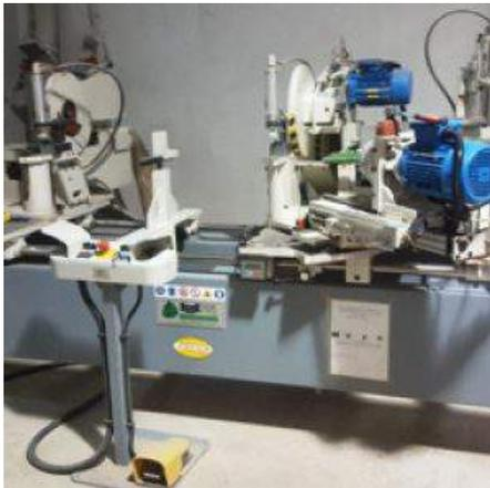
**Descrizione:** TRONCATRICE DOPPIA ESSEPIGI MOD. RAPID B tipo 3000 - a norme CE - lame diam. 350 - apertura manuale con visualizzatore mm.3000 - inclinazione lama e gruppo foratura manuale e visualizzata con cuscino ad aria molto sensibile - n. 5 sec/ciclo - lunghezza di taglio min. mm.160 max mm. 3100 - apertura manuale mm.3000 con visualizzatore - inclinazione lama e gruppo forare manuale e visualizzatore con cuscino ad aria molto sensibile - ingombro mm. 6.000x2000xh.1550
