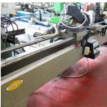
**Descrizione:** TRONCATRICE DOPPIA OMGA MOD. TR2A - motore lame hp 2,2 cad.
