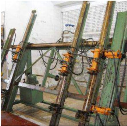
**Descrizione:** STRETTOIO MARZANI MOD. PV-12 - 3000x1500 - 3 montanti - idraulico
