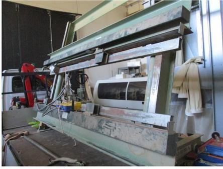
**Descrizione:** STRETTOIO ORMA MOD. FUTURA 30/15 - a norme CE - motore kw 1,5 - da mm. 3000x1500
