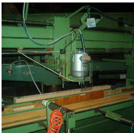
**Descrizione:** fresatrice TRILLO Dati tecnici: - motore fresa watt 2000 - corsa rapida del piano di lavoro mm. 1000 - corsa longitudinale mm. 2300-1200 - corsa trasversale mm.350 - profondità di fresatura mm.100
