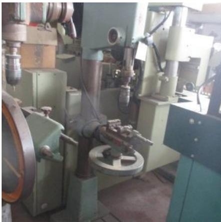
**Descrizione:** TRAPANO A COLONNA - 5 vel. con cambio cinghia - motore 2 velocità: hp 0,8 g7min. 700 hp 1 g7min.1400 - morsa girevole e piatto - v.380
