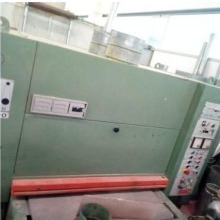
**Descrizione:** CALIBRATRICE SAC MOD. CLSD1000 - motore kw 15 - Primo gruppo: rullo diam. 250 mm. - Secondo gruppo: Tampone, 11 kw - piano flottante tappeto con variatore kw 1,1
