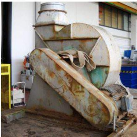
**Descrizione:** VENTILATORE CON MOTORE HP 20 (da controllare perchè senza targhetta) - giri 1400 - bocca di entrata diam. 550 - bocca di uscita diam. 400
