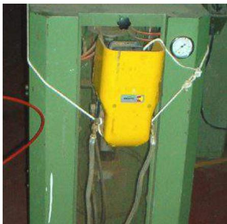
**Descrizione:** GRAFFATRICE MA MOTTA MOD. M1 - DIMENSIONI DELLE ASTE LAVORABILI LARGH.1220 MM, ALT.70 MM. - PRODUZIONE ORARIA POSSIBILE CIRCA 200 CORNICI FINITE - PESO KG.52 - DIMENSIONI 400X400X1150
