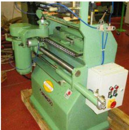
**Descrizione:** FRESATRICE AUTOMATICA PER INCASTRI A CODA DI RONDINE OMEC MOD. 750 - per cassette e parti di mobili - larghezza utile di lavoro mm. 480 - spessore dei frontali dei cassette mm.60 - dimensione fissa del piano mm. 25 - potenza del motore elettrico del mandrino porta punta hp 1,5 2 poli - potenza del motore elettrico traslazione punta hp 1,5 4 poli
