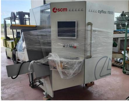
**Descrizione:** CENTRO DI FORATURA SCM MOD. CYFLEX F900 PRO A CNC - a norme CE - testa a forare F18 - moltiplicatore di pressione, dispositivo di aiuto foratura per l'asse Z - supporti laterali per lavorazione pezzi lunghi - lubrificazione centralizzata aut.ca - X-CAB Base Cyflex - Software per arredamento - TELESOLVE per linea NON ISDN
