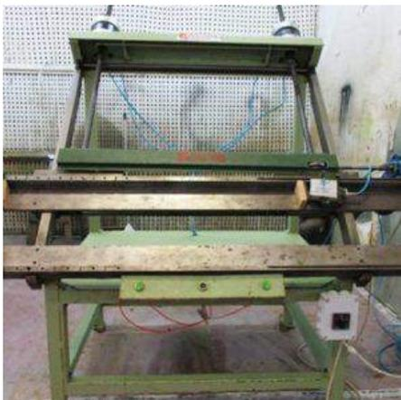
**Descrizione:** STRETTOIO PER ANTINE STROMAB MOD. STA 2500 - larghezza mm. 1200 - lunghezza mm. 2500 - spinta max a 8 bar 2500 mm. - movimentazione laterale motorizzata e chiusura dall'alto motorizzata
