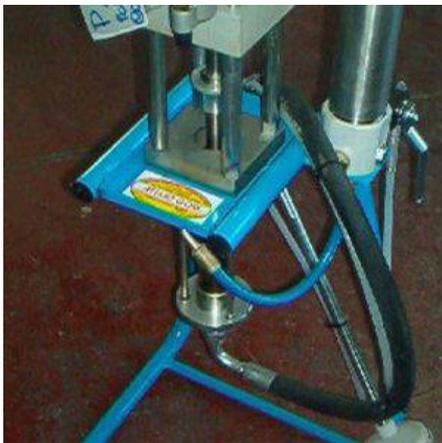
**Descrizione:** POMPA COLORATECNI MOD. T201 - rapporto di pressione 20-1 - portata max l/m 2,5 - pressione aria bar 2%8 - gr.filtro regolatore. lubrificatore, manometro e rubinetto dell'aria - pescante con filtro - valvola e tubazione di ricircolo - tubazione e pistole escluse REVISIONATA
