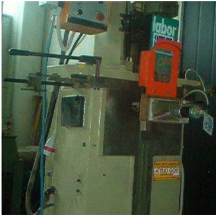
**Descrizione:** MORTASA A CATENA LABOR MOD. CV4S - discesa aut.ca - traslazione manuale - uscita punte aut.ca
