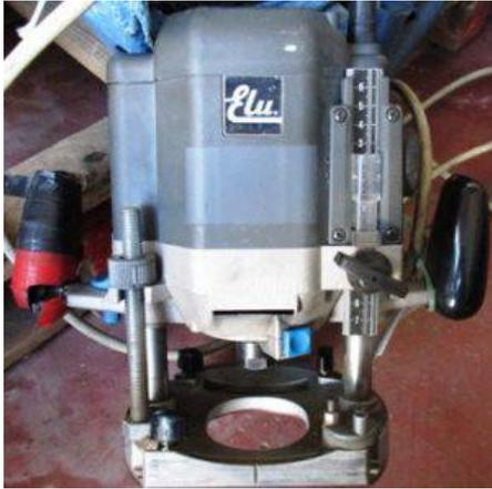
**Descrizione:** PANTOGRAFO MANUALE MOD. MOF 131-QS - a norma CE
