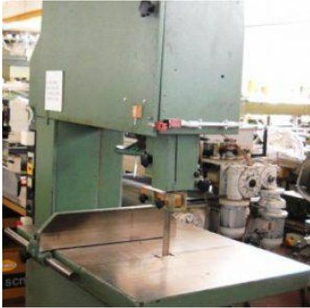
**Descrizione:** SEGA NASTRO PRIMULTINI DA MM. 900 - volani pieni - sviluppo lama 6350x54x0.9 D19 - larghezza volano mm. 50 - motore kw 7,5 hp 10
