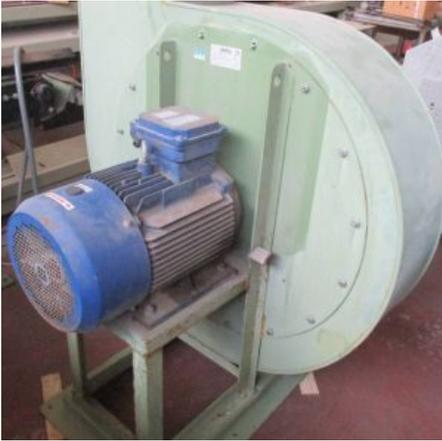
**Descrizione:** ELETTOVENTILATORE STIAVELLI KW 15 - rotazione oraria, vista lato motore
