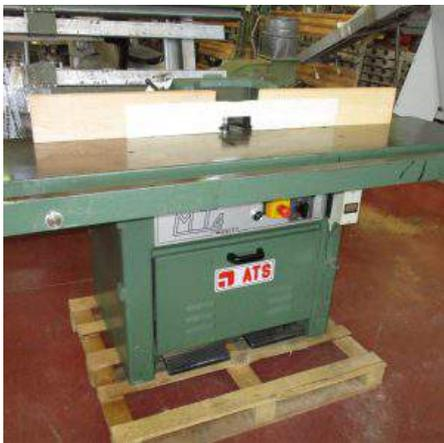
**Descrizione:** Toupie Magic mod. MT4 - piani lunghi mm. 1900 - albero fisso diam. 35 - utensile rientrabile sotto il piano diam.450 - bloccaggio albero a pedale - freno a pedale - sollevamento manuale dell'albero - n.4 velocità 3000-4500-7500-10.000 - inversione di rotazione, avviamento 0 stella triangolo
