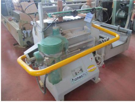
**Descrizione:** CODETTATRICE OMEC MOD. 750 - a norme CE - potenza kw 2,2
