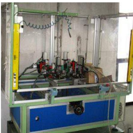
**Descrizione:** MACCHINA PER INCHIODARE CASSETTI ERREPI MOD.DRAWERS 1100 - sistema di assemblaggio per realizzare cassetti di diverse dimensioni con grande versatilità NORME CE
