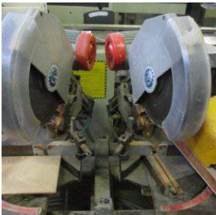
**Descrizione:** Troncatrice doppia Omga mod. TR2A - apertura mm. 2800 - lama diam. 300 - discesa pneumatica teste - motori kw 1,6 cad.
