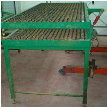
**Descrizione:** BANCO DI COMPOSIZIONE da mm.1000X2250 - per pressa - 2 piani - possibilità di esclusione del piano superiore tramite pistone pneumatico
