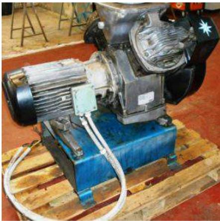
**Descrizione:** COMPRESSORE MOD. LE9 SERIE AML - bar 10 - motore kw 7,5 giri 1445
