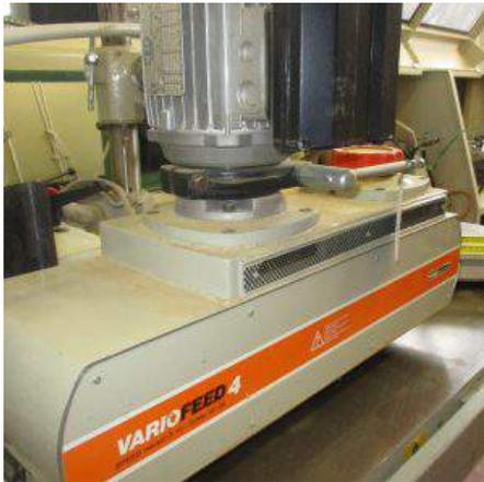
**Descrizione:** TRASCINATORE MAGGI mod. VARIOFEED 4 - a normative CE - n. 4 ruote - feed mt./min 3-18 - ft/min 10-59
