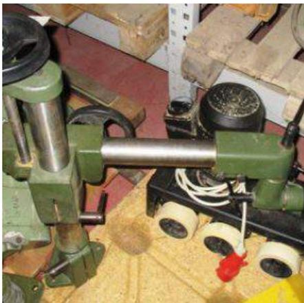
**Descrizione:** TRASCINATORE 4 RUOTE - 2 velocità trifase kw 0,6
