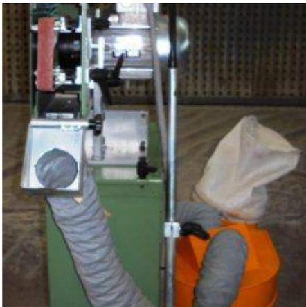
**Descrizione:** LEVIGATRICE FINTEC ORIZZONTALE - con nastro mm. 30 - con aspirazione e luce
