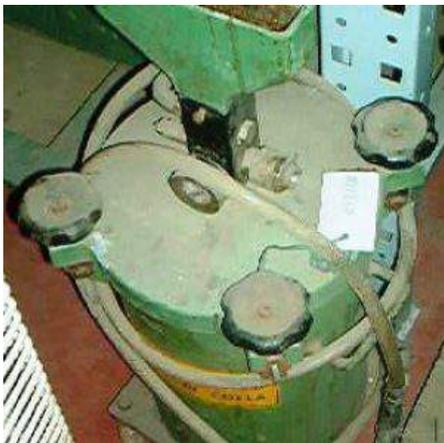
**Descrizione:** EROGATORE DI COLLA - 1 spruzzatore - da kg. 10
