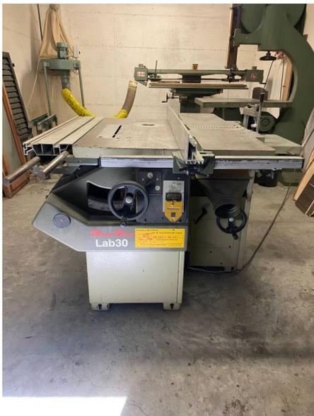
**Descrizione:** COMBINATA MINIMAX MOD. LAB30 - motore hp 3
