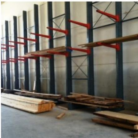
**Descrizione:** CANTILEVER FIMAT Così composto: - N.12 colonne - N.18 mensole lunghezza cm 120. cad. portata 900 kg. - Altezza cantilever da terra mt 6. - Base cm 30 - Interasse colonne cm 150 - Colonna per fronte portata 4050 kg. N.B. la macchina viaggia senza documenti e non ha CE. Come documento fa fede la targhetta apposta sul cantilever.
