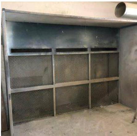
**Descrizione:** Cabina di verniciatura da mt.3 kw 2,2
