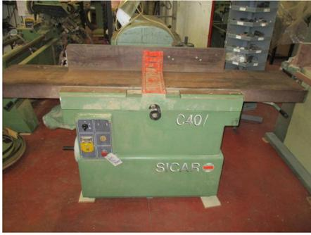
**Descrizione:** PIALLA FILO SPESSORE SICAR MOD. C.40/3 - MOTORE HP3 - VOLT 220
