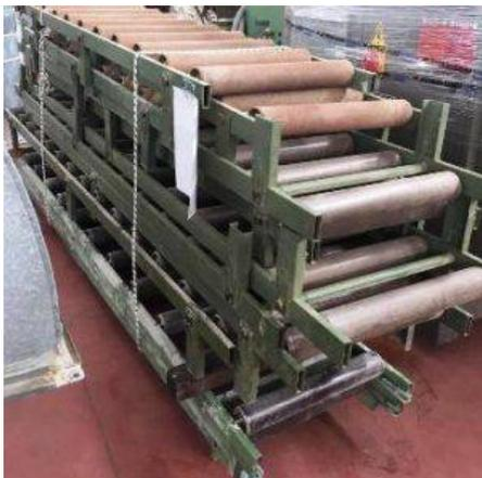
**Descrizione:** n.3 RULLIERE da mm. 2000 - altezza da terra mm.240 - larghezza mm. 500 - rullo diam. mm. 75 - passo 20 mm. n.6 RULLIERE da mm. 3000 - altezza da terra mm.240 - larghezza mm. 500 - rullo diam. mm. 75 - passo 20 mm. n.2 RULLIERE da mm. 3000 - altezza da terra mm.240 - larghezza mm. 500 - rullo diam. mm. 75 - passo 25 mm.
