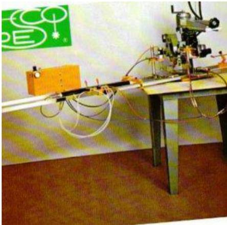
**Descrizione:** APPARECCHIO PER RADIALE RESCO 82 Apparecchio divisore universale aut.co brevettato "resco 82". Applicabile su seghe circolari radiali per realizzare scanalature, sagomature e fresature su regoli e pannelli in legno e plastica con rotazione del supporto porta pezzi da 0° a 45° a destra e sinistra rispetto all'asse neutro del piano orizzontale.
