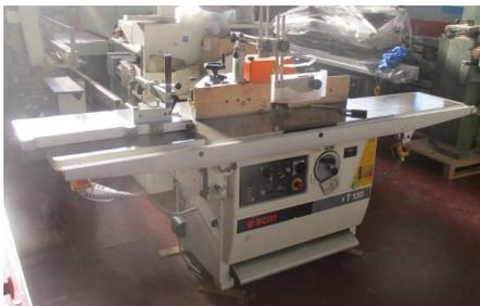
**Descrizione:** TOUPIE SCM MOD. T130N - versione TL - a norma CE - utensile a profilare max diam. 250 mm. - utensile a tenonare max diam. 300 mm.
