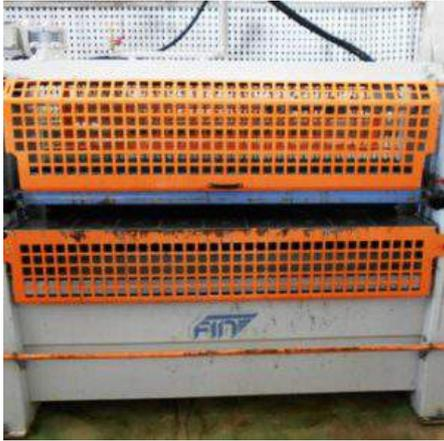
**Descrizione:** INCOLLATRICE FIN TIPO SCRR 1300 - a normative CE - potenza kw 0.55 v380 fasi 3 hz 50
