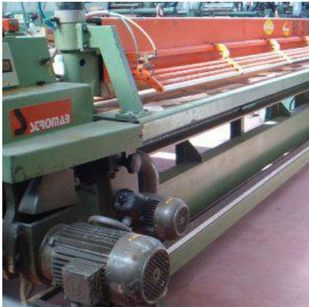
**Descrizione:** REFILATRICE STROMAB mod. RF 310 - lunghezza mm. 3100 - n.2 piani appoggio post. - motore lama hp5,5 - motore incisore hp 0,75 - diam. lama 180 mm. - diam. foro lama 20 mm. - giri lama g/min 9000 - altezza di taglio registrabile con lama diam. 180 mm. da 0 a 45 mm. - altezza di taglio registrabile con lama diam. 200 mm. da 0 a 55 mm. - larghezza max rifilatura mm. 1300 - larghezza min rifilatura mm. 25 Dimensioni d'ingombro: mt. 4,80x2,20
