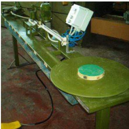
**Descrizione:** BANCO ATTREZZATO PER SALDATURE/ASSEMBLAGGIO GUARNIZIONI DA FINESTRA
