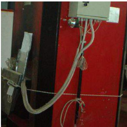
**Descrizione:** CALDAIA COMAFER TURBOMATIC MOD. T150 - pressione d'esercizio 2 kg./cm2 - temperatura 90° c - capacità lt.400 - potenza focolare 200.000 k/cal/h - potenza al nominale 150.000 k/cal/h + alimentatore con coclea: \*altezza utile mm. 900 \*diam. interno mm.1000 \*lunghezza coclea mm. 600 \*diam. coclea mm. 120 + contenitore con alimentazioen a coclea
