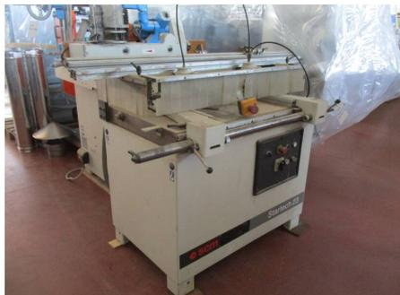
**Descrizione:** FORATRICE SCM MOD. STARTECH 23 - a norme CE - sollevamento della testa a forare manuale servo-assistito da molle a gas - la regolazione in continuo della profondità di foratura con revolver meccanico - preciso revolver meccanico per forature a 45° - coppia di guide lunghe
