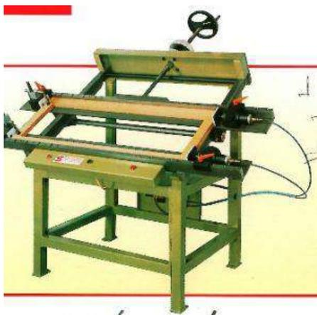
**Descrizione:** STRETTOIO PER ANTINE STROMAB MOD. STA 2000 - larghezza mm. 780 - lunghezza mm. 2000 - spinta max a 8 bar kg 1300
