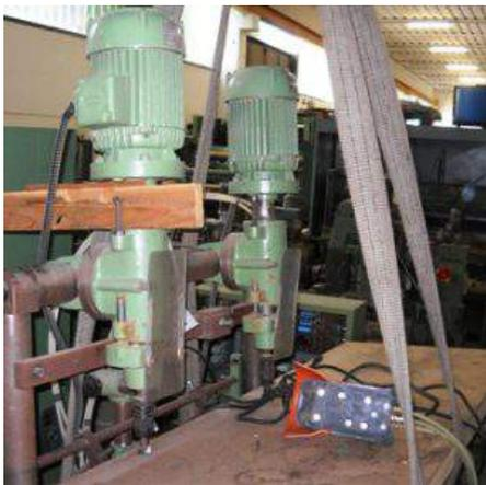
**Descrizione:** FORATRICE VERTICALE SORBINA 50 - a due teste con motore di hp 1,5 cad.
