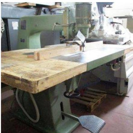
**Descrizione:** PANTOGRAFO VITAP DA 770 MM. - discesa meccanica - con convertitore - 2 velocità 12.000/18.000 - con freno
