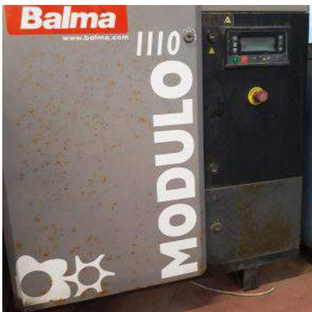
**Descrizione:** Compressore a vite Balma mod. Modulo 11 - kw 11 - portata aria libera 1.40 m3/min. - a normative CE
