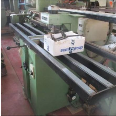
**Descrizione:** FORAINSERITRICE PER CERNIERE MAW MOD. BEV - 220/380 kw 1.6
