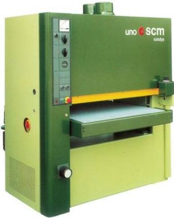
**Descrizione:** CALIBRATRICE LEVIGATRICE AUTOMATICA SCM MOD. SANDYA UNO C-CS Dati tecnici: - mm. 920 - altezza max di lavoro mm. 160 - altezza min di lavoro mm. 3 - dimensione nastri abrasivi mm. 930x1525 - potenza motore principale hp 10
