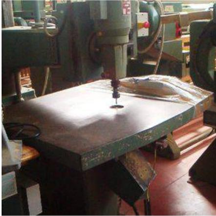
**Descrizione:** PANTOGRAFO PFEIL MOD. HF723 - con convertitore - sbraccio 850 mm. - motore hp 4,5 - v110-160 - giri 12000-18000
