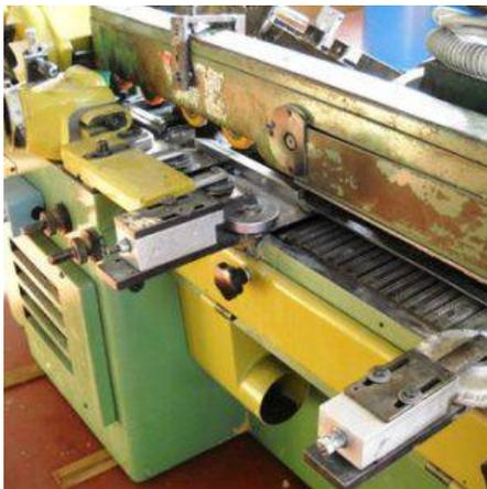
**Descrizione:** SCORNICIATRICE GABBIANI MOD. GS 120 - potenza assorbita kw 16 - corrente 30 amper Composizione: - n.6 alberi \*nastro trasportatore in entrata \*1) albero pialla \*2) albero verticale dx \*3) albero verticale sx \*4) albero orizzontale superiore \*5) albero orizzontale inferiore \*6) albero orizzontale superiore - possibile abbinare cabina insonorizzata
