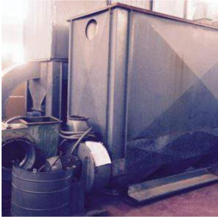
**Descrizione:** SOTTOSTAZIONE - mt.3 6000 - n. 48 maniche diam. 200 lunghezza mm. 1680 - aspiratore trucioli ME2 kw 7,5 hp 10 giri 2910 - n.1 motore trasporto trucioli hp 7,5 giri 2860 - con quadro elettrico
