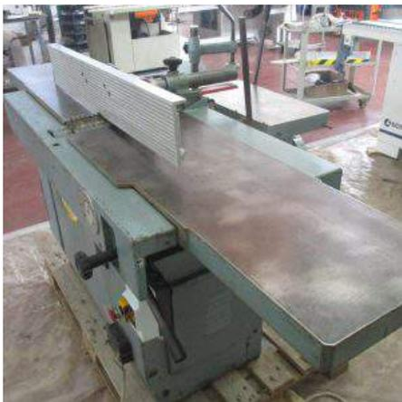
**Descrizione:** PIALLA FILO CON BUCATRICE SICAR MOD. FB350 - motore kw 2,2 - v.380/50 - amper 4,8
