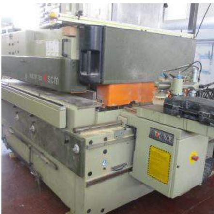
**Descrizione:** CENTRO DI LAVORO SCM MOD. MULTIFLEX C - lunghezza max lavorabile (con riferimento su battute) mm. 2800 - spessore minimo pezzo mm. 30 - spessore massimo pezzo mm. 140 Composizione: - n.2 alberi a profilare: lunghezza utile mm. 320 - recupero listello: diam. utensile max mm. 220 - albero a tenonare: lunghezza utile mm. 320
