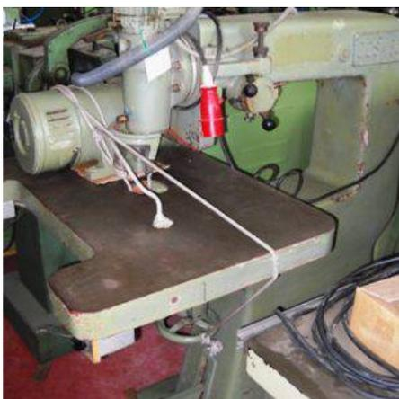
**Descrizione:** PANTOGRAFO COSMEC - da 700 con convertitore kw 2,7/4 - discesa meccanica
