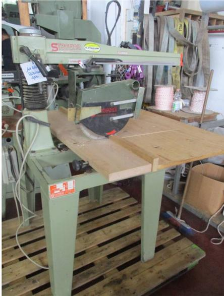
**Descrizione:** RADIALE STROMAB MOD. RS65 - motore hp3 trifase - lama diam. 300
