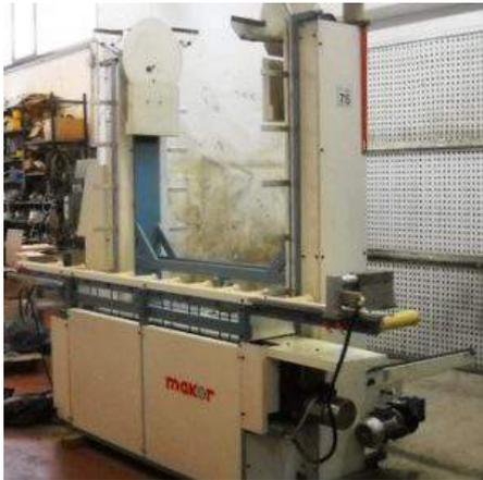
**Descrizione:** CARICATORE PER CARRELLI MAKOR MOD. ACA/2 - interasse tra catena e catena mm. 1500 Fine linea - a norme CE - con n. 4 carrelli per essiccazione \*interasse di ciascun carrello 160 \*n.12 bracci da nmt.1 cad. per ogni carrelli Fine linea
