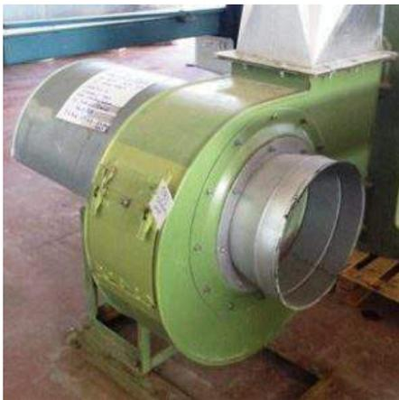
**Descrizione:** ELETTOVENTILATORE CON PROTEZIONE MOTORE - raccordi
