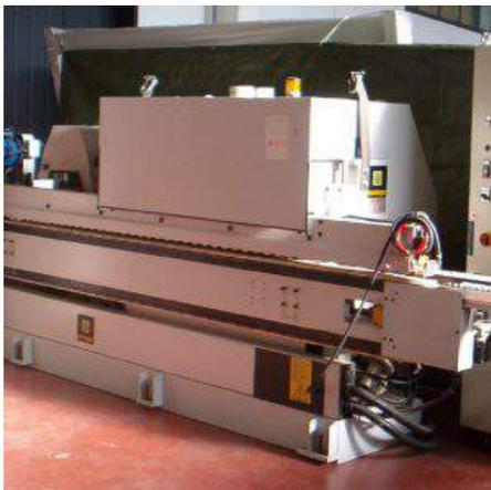
**Descrizione:** LEVIGABORDI TECNOLEGNO MOD.COMPACT 40 - MOTORE KW 16 - a norme CE COMPOSIZIONE: 1) GRUPPO TOUPIE C/INVERSIONE HP 5.5 2) GRUPPO SPIGOLATORE SUPERIORE HP 1 3) GRUPPO SPIGOLATORE INFERIORE HP 1 4) GRUPPO LEVIGATORE C/INVERSIONE HP 1.8 5) GRUPPO FRESA/SPAZZOLA HP 3 CON INVERSIONE IN POSIZIONE DX 6) GRUPPO FRESA/SPAZZOLA UNIVERSALE CON INVERSIONE HP 5.5 IN POSIZIONE SX CONTROLLO ELETTRONICO
