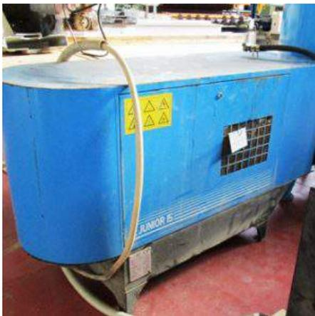
**Descrizione:** COMPRESSORE A VITE JUNIOR 15 10 - a norme Ce - pressione d'esercizio max 10 bar
