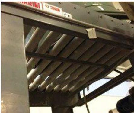
**Descrizione:** RULLIERA MOTORIZZATA MOD. TRANSFER T 20 R - a norme CE - dimensioni larghezza mm. 1530 (utile mm.1420) x lunghezza totale mm. 2000 - altezza con piedino cm. 91 - altezza senza piedino cm. 86 - motore kw 0,4 v380/50 - n.8 rulli al mt. (per un totale di n.16 rulli) diam.80 interasse 22,5 lunghezza mm. 140 - lunghezza da rullo a rullo cm. 194
