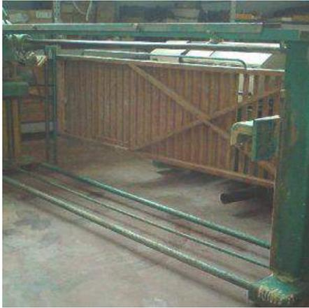
**Descrizione:** LEVIGATRICE A NASTRO DA MT. 3 - sollevamento motorizzato - motore a 2 vel. hp.2,5 hp.3
