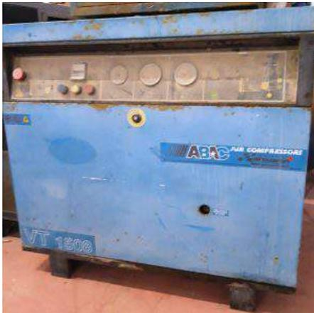
**Descrizione:** Compressore a vite Abac mod. VT 1508 - kw 11 - pressione 8 bar - aria aspirata 1,70 m3/min
