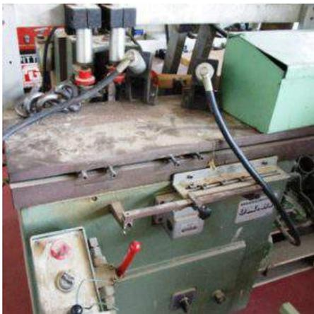
**Descrizione:** BEDANATRICE MUTI MOD. OMB1 - a una testa - doppio pressore verticale e frontale - motore hp3 2 poli - profondità max della cava 130 mm. - regolazione verticale della testa 100 mm. - dimensioni della tavola 1000x300 mm. - altezza del piano di lavoro 820 mm. - pressione di lavoro 6-8 bar - consumo aria per ciclo lt. 15
