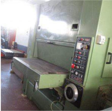
**Descrizione:** CALIBRATRICE FIMEC TIPO H160L CLS 1150 - 1 RULLO - motore hp 25 kw 18,5
