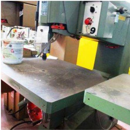
**Descrizione:** PANTOGRAFO SCM MOD. R9 Caratteristiche tecniche: - testa flottante - distanza fra albero e montante mm.915 - velocità albero 10000-20000 giri/min. - motore hp 5,5 - corsa verticale albero mm.110 - corsa verticale piano mm.200 - max distanza fra piano e mandrino mm.310 - n.6 battute registrabili - dimensioni del piano mm.905x770 - inclinazione albero fino a 60°
