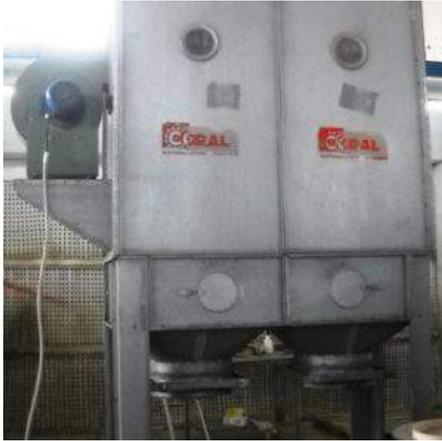
**Descrizione:** UNITA' FILTRANTE CORAL MOD. MS - lunghezza mm. 1900 larghezza mm. 1000 altezza mm. 3900 - a 2 sacchi diam. 500 mm. - carenato - motore hp 4 - sporgenza motore 80 cm.
