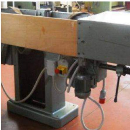
**Descrizione:** LEVIGATRICE NATRIBOM - orizzontale - con piano d'appoggio da mm. 1200x450 - regolabile in altezza - altezza nastro mm. 200
