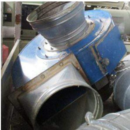
**Descrizione:** MOTORE PER FILTRO kw 7,5
