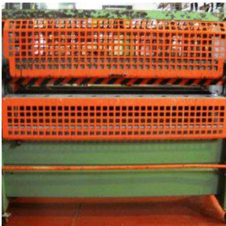
**Descrizione:** INCOLLATRICE FIN MOD. SC2 R 1300 - a normative CE - potenza kw 0,37 - a due rulli da mm. 1300
