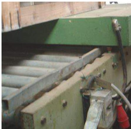
**Descrizione:** FORNO A LAMPADE CVM ES 7,5 POTENZA KW 7,5 A 6 LAMPADE RULLIERA MOTORIZZATA LUNGHEZZA 2500 LARGHEZZA 1300 ALTEZZA 850
