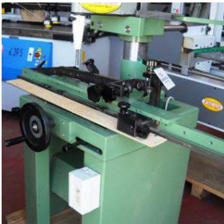
**Descrizione:** CAVETTATRICE PER PERSIANE PER CURVI FIN MOD. CP.86/800 - motore trifase hp2 - giri punta 14.000 - dimensioni cm. 1300x950x1970 - peso netto 170 kg. - inclinazione delle cave regolabile 0°- 65° - possibilità di eseguire sestri fino ad un raggio mm.800 - peso delle cave a richiesta n. passi 4 - diametro punta a richiesta mm.9/12
