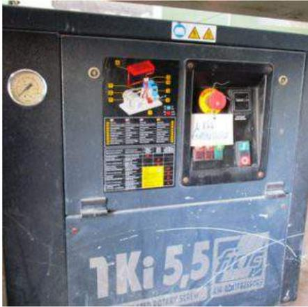
**Descrizione:** COMPRESSORE A VITE FIAC TKI 5,5 a norme CE - aria res al/min. 420
