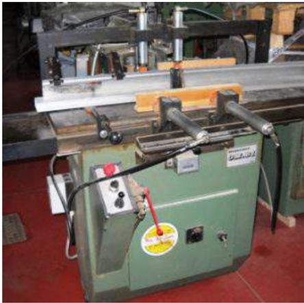
**Descrizione:** BEDANATRICE MUTI MOD. OMB1-ECO - automatica - a una testa - doppio pressore verticale e frontale - motore hp3 2 poli - profondità max della cava 130 mm. - regolazione verticale della testa 100 mm. - dimensioni della tavola 1000x300 mm. - altezza del piano di lavoro 820 mm. - pressione di lavoro 6-8 bar - consumo aria per ciclo lt. 15
