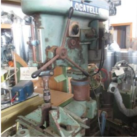
**Descrizione:** TRAPANO A COLONNA LOCATELLI CON MORSA autocentrante pneumatica
