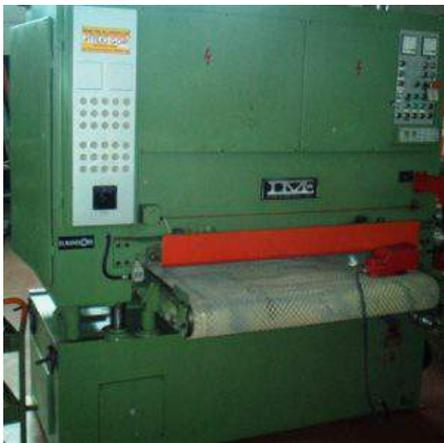
**Descrizione:** CALIBRATRICE DMC DA 1300 - SVILUPPO NASTRI 2620X1350 ad un nastro - RULLO/SCOTCHBRYTE/spazzola - variatore di velocità primo rullo con variatore - rullo 30sh (verificare se v'è rivulcanizzato) - tappeto SEMINUOVO - soffiatori - tampone sul piano o tappeto - velocità variabile sul tappeto - macchina da linea: piano fisso gruppi che scendono dal sopra - misuratore del pezzo
