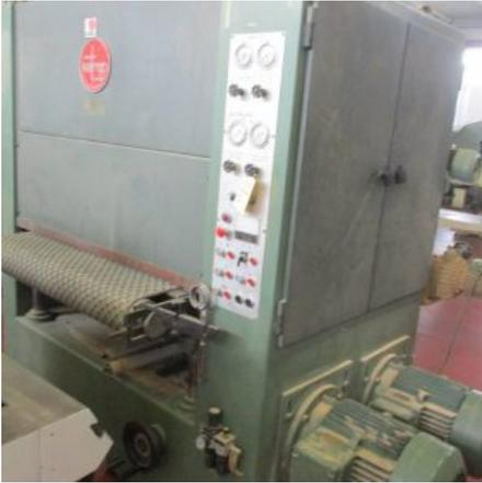
**Descrizione:** CALIBRATRICE VIET da 1000 - a 2 gruppi: \*primo gruppo in gomma 85 sh diam. 300 motore hp 15 \*secondo gruppo tampone motore 2 vel. hp 12/15 - hp.2 - satinatore in uscita - soffiatori primo gruppo e secondo gruppo - tappeto avanzamento con motovariatore
