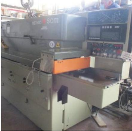
**Descrizione:** CENTRO DI LAVORO SCM MOD. METHOD K - a norme CE - SENZA UTENSILI - spostamento manuale dell'inclinazione guida porta pezzo, visualizzata da controllo, applicazione su guida con battuta manuale - potenza hp15 gruppo pos.2, hp 15 gruppi 3/ (?) - battuta di lunghezza pezzo
