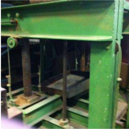
**Descrizione:** PRESSA 2500x1200 - piani in legno - discesa meccanica - piano superiore sezionato in 3 pezzi: \*1° mm. 640x1200 \*2° mm.1070x1200 \*3° mm. 860x1200
