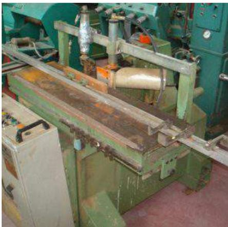
**Descrizione:** BEDANATRICE LARI MOD. LB1S - motore kw 3 - elettronica - 1 testa operatrice - bancale mm. 1000x300 - asta mt.3 con 8 battute - n.3 profondità di cava - tavola mobile corsa mm.400
