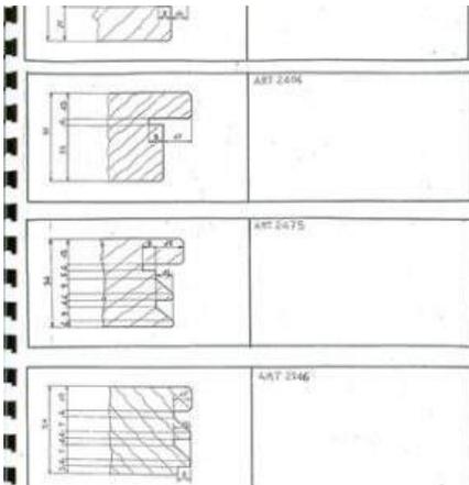
**Descrizione:** GRUPPO PER FINESTRE RESCO spessore 54 foro 50 SERIE DOPPIA NOCELLA COSI' COMPOSTO: TELAIO - tenone maschio telaio - tenone femmina inferiore telaio - tenone femmina superiore telaio - profilo inferiore telaio - profilo superiore telaio - profilo laterali telaio ANTA - squadratura anta ricevente - squadratura anta battente - squadratura ante laterali - squadratura ante superiore e inferiore
