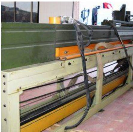
**Descrizione:** Sezionatrice Scm mod. ALFA45C - a normative CE - profondità di taglio mm. 3500 - n.2 pianetti a velo d'aria mm. 1500 - n.1 pianetto a velo d'aria mm. 2500 - n.8 pinze
