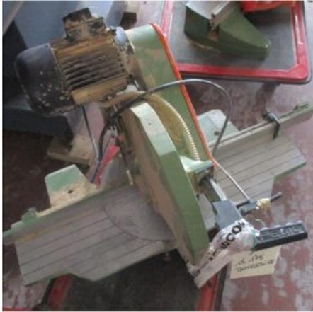
**Descrizione:** Troncatrice Pertici Gp30 Ort - a norme Ce - kw 1,5 - lama diam. 350 f.30 mm. sp. 3,2 mm. - peso kg 1,2
