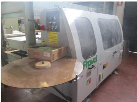
**Descrizione:** BORDATRICE FRAVOL MOD. SMART - S100SE - a normative CE - Composizione: \*gruppo incollaggio \*taglierina \*intestatori \*gruppo refillatori sopra e sotto \*raschiacolla Dati tecnici: - spessore pannello mm. 10-60 - larghezza pannello min. 60 mm. - larghezza bordo mm. 15-65 - spessore bordo mm. 0,4-8 - potenza motore kw 5,6
