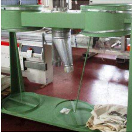
**Descrizione:** ASPIRATORE IMAS MOD. ECO 2/30 P - a norme CE - a due sacchi di raccolta diam. 500 - motore kw 2,2 - V.380 HZ50 A.5.2
