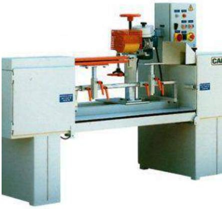
**Descrizione:** LEVIGATRICE A NASTRO ORIZZONTALE CAMAM MOD. LO/3V/75/T - potenza kw 5,75 - peso kg. 550
