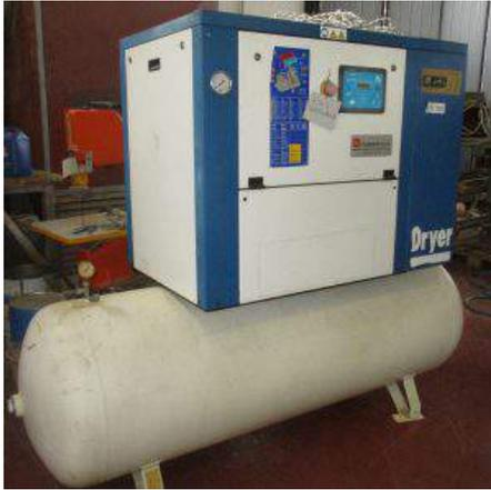
**Descrizione:** COMPRESSORE A VITE FIAC MOD. CRSD15/500 - a normative CE - REVISIONATO - SENZA ESSICCATORE - aria resa L/min. 1450 - ampere max 21,1 v.400/50/3 - pressione max bar 10 - potenza assorbita kw 12,9 - peso kg. 456
