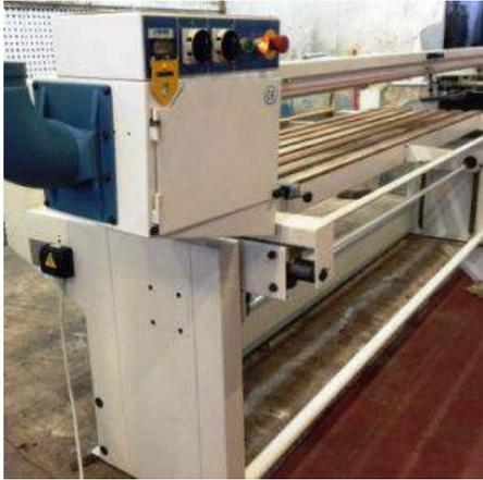
**Descrizione:** LEVIGATRICE A NASTRO SAMCO MOD. LL3000 - sollevamento motorizzato - motore 2 vel. 1450-2800 g/min. hp3 vel. 2800 g/min. hp4 - gruppo aspirante
