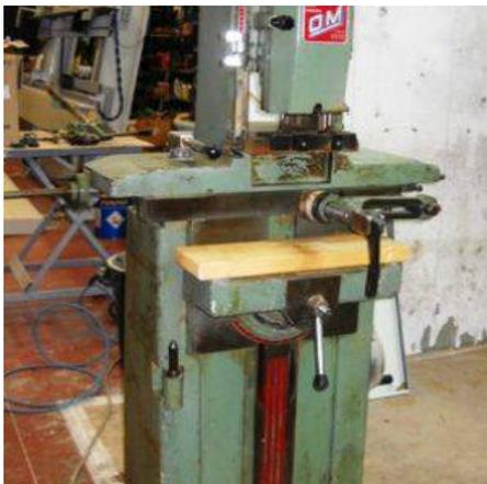
**Descrizione:** CAVATRICE A CATENA OM - discesa testa e spostamento manuale - piano fisso - testa mobile - motore hp 3
