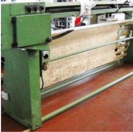
**Descrizione:** LEVIGATRICE A NASTRO DA MT. 3 - doppio collo d'oca - sollevamento motorizzato del piano - motore a due velocità 1400-2800 - motore hp4+3
