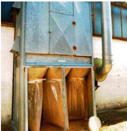
**Descrizione:** FILTRO - n.3 sacchi di raccolta diam. 600 - con elettroventilatore - n.18 maniche diam.250 lunghezza mm.1500 - motore kw 5,5/hp 7,5
