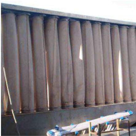
**Descrizione:** FILTRO A 4 SACCHI DI RACCOLTA DIAM.500 - n.48 maniche filtranti diam200x1500 - motore hp 7,5 - senza carenatura - senza scuotitore
