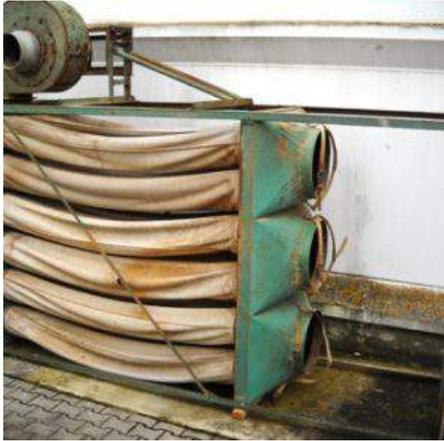
**Descrizione:** ASPIRATORE A 3 SACCHI DI RACCOLTA DIAM. 500 - n. 18 maniche filtranti: diam. 250 mm. lunghezza 2.000 mm. - motore kw 5,5
