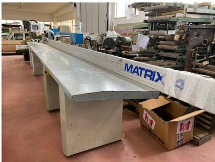
**Descrizione:** TRONCATRICE OTTIMIZZATRICE AUT.CA STROMAB MOD. TR500 MATRIX 4 - a norme CE MATRIX 4 - banco da mt. 5 TRONCATRICE TR500 - diam. max mm. 500 foro 30 mm. - diam. min mm. 490 foro 30 mm. - motore kw 7,5
