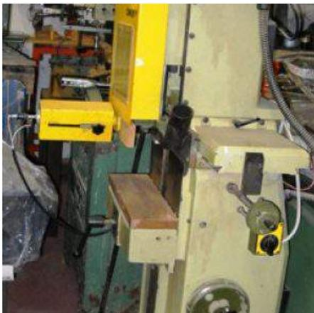
**Descrizione:** BEDANATRICE MUTI MOD. OMB1 V Dati tecnici: - motore testa hp3 - 2 poli - corsa verticale testa mm. 150 - corsa longitudinale mm. 270 - corsa trasversale testa mm. 80 - corsa verticale piano di lavoro mm. 260 - altezza max della porta mm. 1000 - pressione di esercizio 6 bar - cava min. con sola entrata dell'utensile: \*spessore mm. 2 \*lunghezza mm.20 \*profondità 35 mm. - cava max con una sola entrata dell'utensile: \*spessore mm. 20 \*lunghezza mm. 75 \*profondità mm. 110
