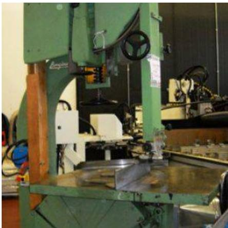
**Descrizione:** SEGA NASTRO BONGIOANNI - da mm. 900 - potenza motore kw7,5 HP10 - volani pieni
