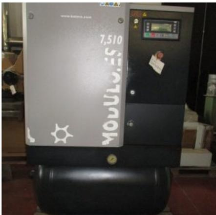
**Descrizione:** Compressore Balma mod. MODULO ES 7,5 - a norme CE - portata aria libera m<sup>3</sup>/min 1,04 - pressione esercizio 10 bar - potenza kw 7,5 - serbatoio lt.270 - completamente revisionato
