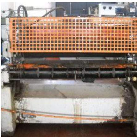
**Descrizione:** INCOLLATRICE FIN MOD. SC4 1300 Dati tecnici: - larghezza di lavoro mm. 1300 - passaggio massimo tra i rulli - diametro dei rulli mm. 120 - diametro dei rulli mm. 250
