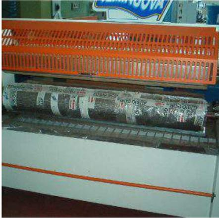
**Descrizione:** INCOLLATRICE FIN TIPO SC288 1300 - a 2 rulli diam.200 da mm. 1300 (rigati a mm.1,5 per dosare la colla a 120 gr. a mt. quadro) - revisionata a nuovo
