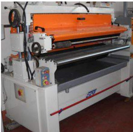
**Descrizione:** INCOLLATRICE FIN MOD. SC4/1300 - a norme CE - completamente revisionata - a 4 rulli da mm.1300 - con lavatori - passo 1,2/1,3 prof.7/10 - per cm.2,5 ci sono 17 gole e 17 dentini - larghezza di lavoro mm.1300 - passaggio massimo fra i rulli mm. 120 - diam. dei rulli mm.250 - velocità di avanzamento mt./1' 19 - potenza di ciascun motore hp 1 - dimensioni ingombro: \*lunghezza mm. 2300 \*larghezza mm. 1100 \*altezza mm. 1700 - peso kg. 900
