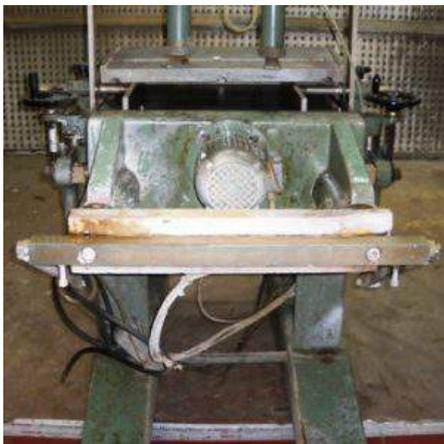
**Descrizione:** FORATRICE AUTOMATICA A 20 MANDRINI - attacco filettato - foratrice orizzontale verticale con spostamento manuale - 2 pistoni di bloccaggio pezzi pneumatici - motore hp 2
