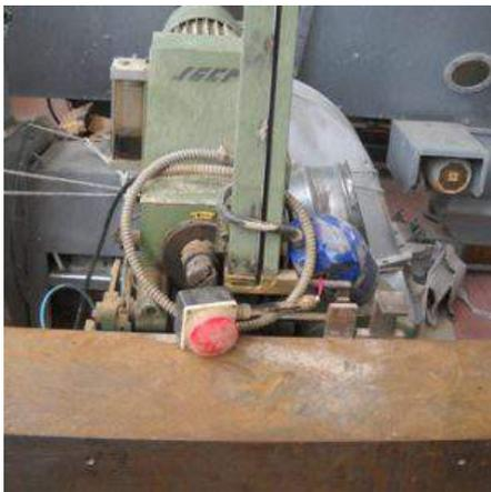
**Descrizione:** ANUBATRICE SICAR MOD. SGCP FA1P - con posizionatore con controllo per posizionamento testa e avviamento ciclo - a 1 testa - attrezzata per anuba da 14 (?)
