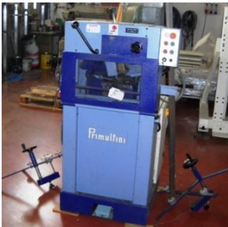
**Descrizione:** AFFILATRICE PRIMULTINI MOD. APB - a norme CE - passo di dentatura mm. 5/25 - larghezza lama mm. 15/110 - angolo d'attacco 5°/30° - dimensione della mola mm. diam. 200 - diam.15x70
