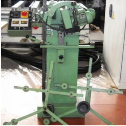
**Descrizione:** AFFILATRICE ORIZZONTALE PRIMULTINI MOD. APA 66 - motore mola 0,18 hp - diam. max mola 200 - passo dente 5-25 - larghezza lama da 15 a 60 mm. - angolo d'attacco da 5 a 20 gradi - spessore mola 7 mm.. - foro mola 15 mm. - motore cricco 0,18 kw - peso macchina 180 kg
